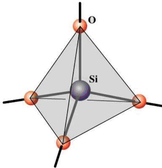
**FIGURA 1:** Representação de um tetraedro constituído de um átomo de silício central e quatro átomos de oxigênio nos vértices.
