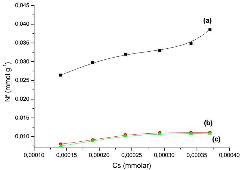
**FIGURA 24** - Isothermas de interação do AD em Vs (a), V/Cu (b) e V/Co (c) em solução aquosa a 298 K e 1 atm.
