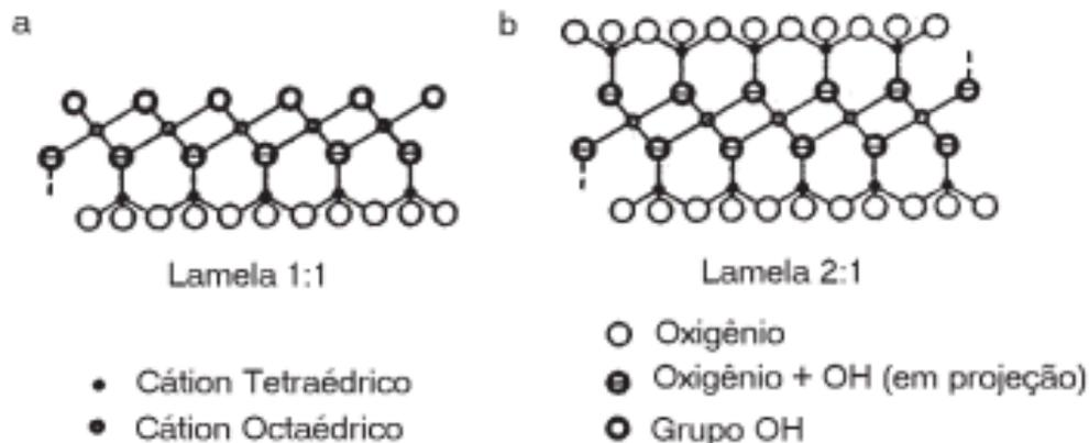
**FIGURA 3:** Representação dos arranjos de filossilicatos do tipo a) 1:1 e b) 2:1.
