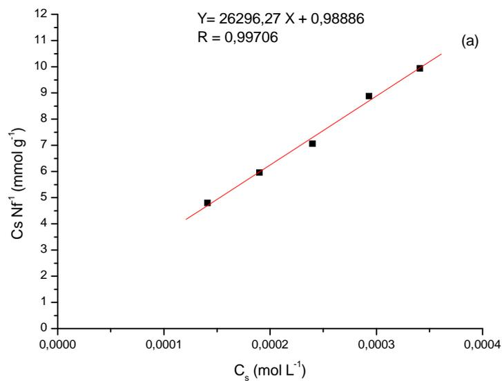
**FIGURA 21** - Isothermas de interação do corante **AM** em **Vs** (a) em solução aquosa a 298 K e 1 atm.
