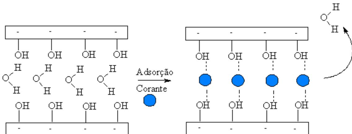
**FIGURA 19** – Proposta da interação do corante com as vermiculitas ácidas.
