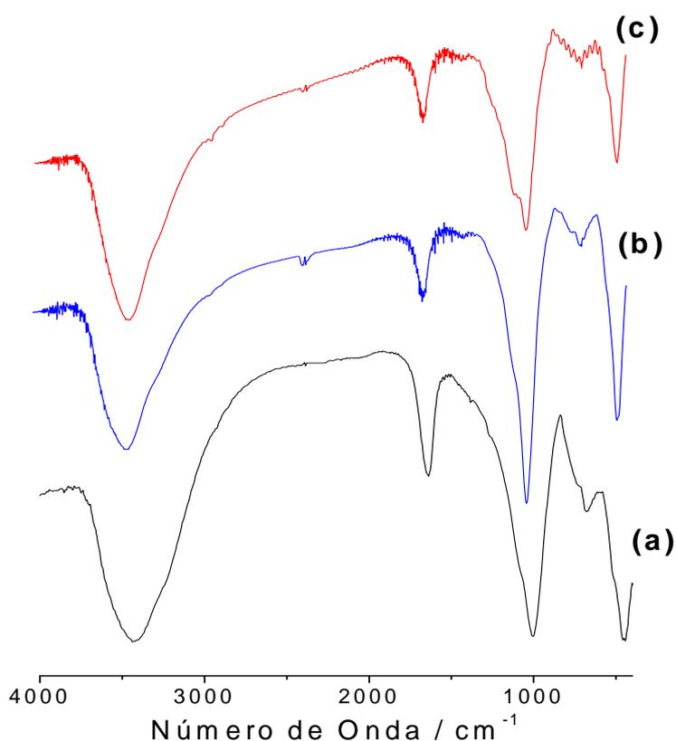
**FIGURA 12** – Espectro na região do infravermelho da **Vs** (a) **V/Cu** (b) e **V/Co** (c).
