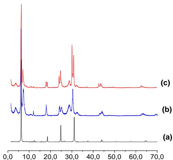
**FIGURA 26** – Dados de DRX da Vs (a) e após sua interação com os corantes AM (b) e AD (c).
