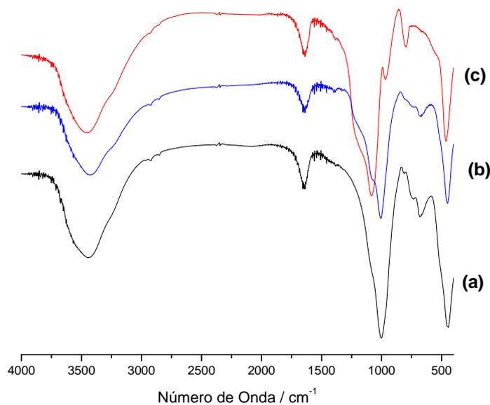
**FIGURA 28** - Espectros de absorção no infravermelho para **Vs** (a) e suas formas lixiviadas **Vac1**(b) e **Vac3** (c) modificada com o **AD**.
