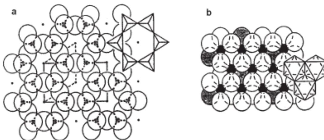
**FIGURA 2:** Constituintes dos filossilicatos: a) visão planar de uma camada tetraédrica hexagonal ideal e b) camada octaédrica com grupos hidroxila no interior.
