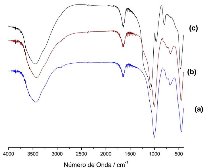
**FIGURA 27** - Espectros de absorção no infravermelho para **Vs** (a) e suas formas lixiviadas **Vac1**(b) e **Vac3** (c) modificada com **AM**.
