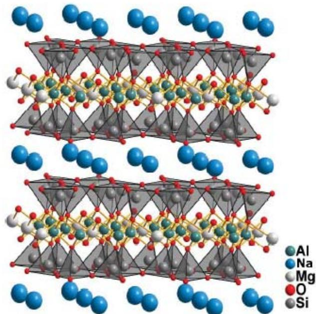
**FIGURA 4:** Estrutura da vermiculita.
