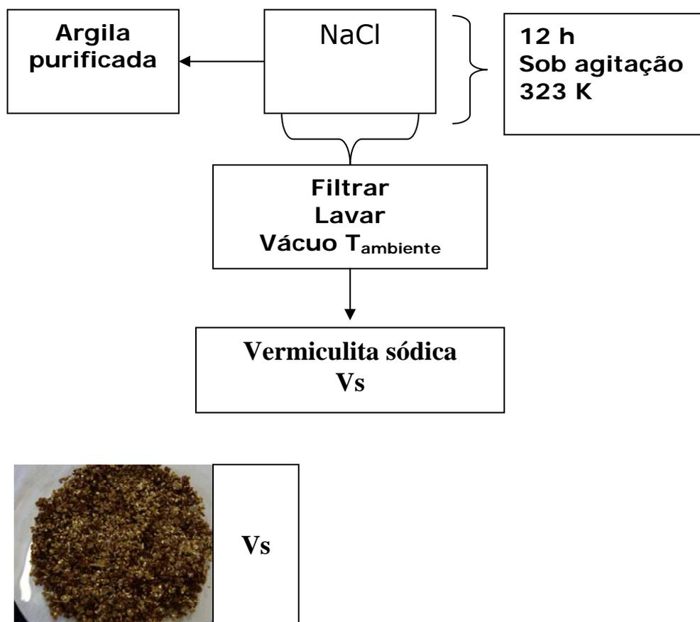
**FIGURA 8:** Esquema da obtenção da argila monoiônica.
