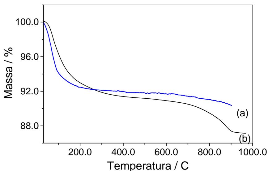
**FIGURA 14** – Dados de termogravimetria da Vs (a) V/Co (b)
