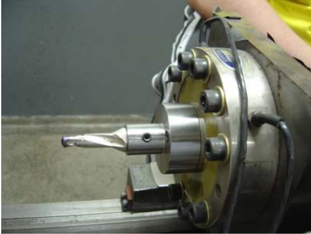
Foto da célula de carga montada na máquina
