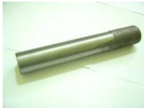
Figura 4.9 – Primeiro desbaste do tarugo
