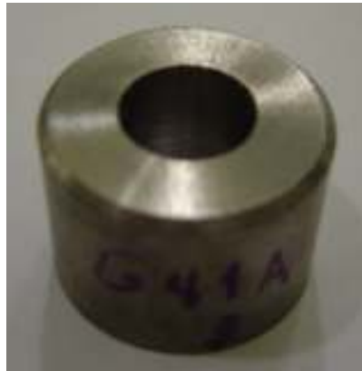
Figura 4.12 – Corpo de Prova furado após ensaio
