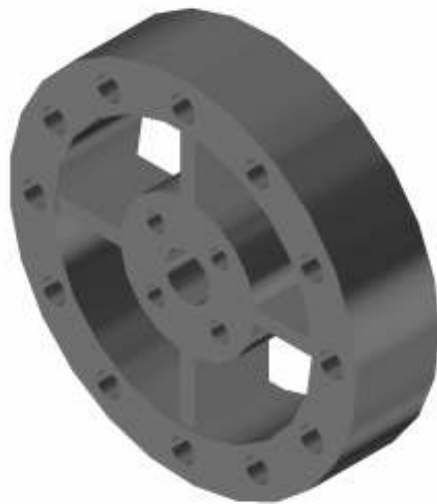
Figura 4.18 – Detalhe interno da célula de carga (CAPUANO, 2004)
