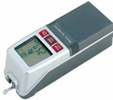
Figura 4.20 – Foto do Rugosímetro portátil SurfTest SJ-201P
