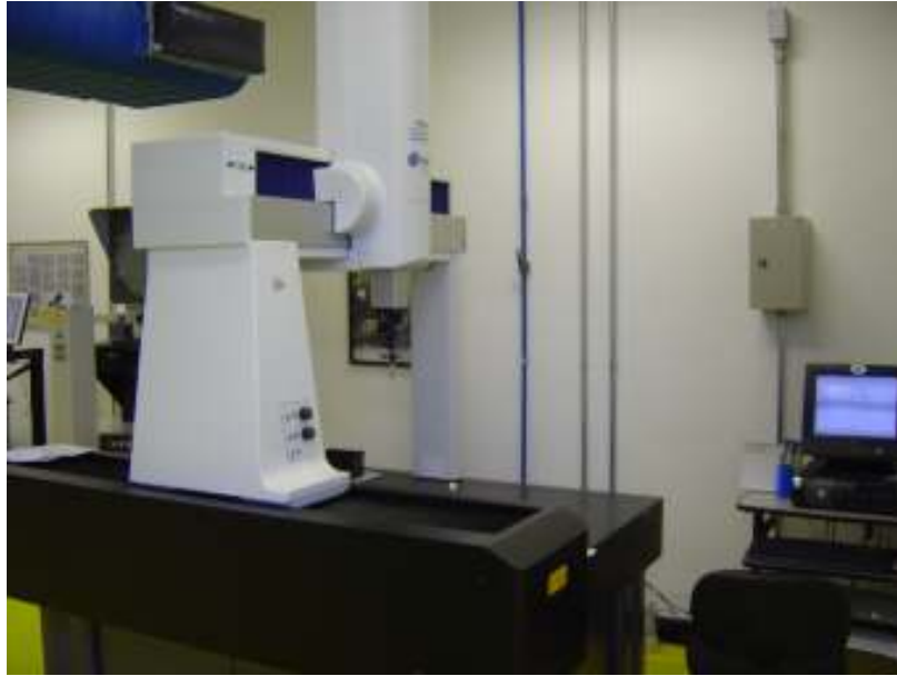
Figura 4.21 – Foto da Máquina de Medir Coordenadas Crysta-Plus M7106
