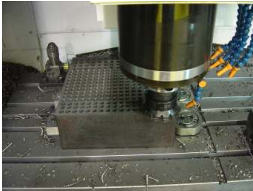
Figura 4.3 – Início do fresamento do bloco para uma nova bateria de furação
