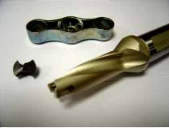
Figura 2.7 – Ilustração da broca Chamdrill
