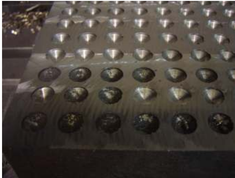
Figura 4.4 – Bloco fresado uma etapa anterior ao faceamento final
