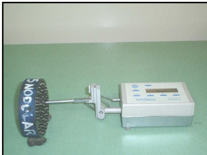
Figura 3.19 - Rugosímetro surftronic 3+ da Taylor Hobson em posição de funcionamento
