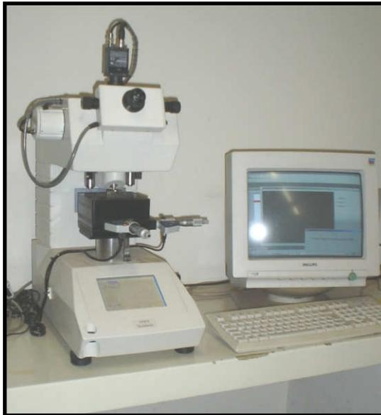
Figura 3.22 - Microdurômetro Shimadzu e software HMV-AD
