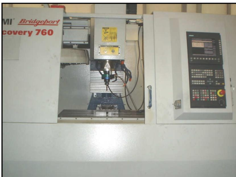
Figura 3.9 - Centro de Usinagem CNC Discovery 760, utilizado nos testes de furação
