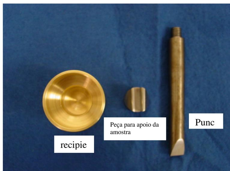
Figura 12 – Componente do dispositivo e punção utilizados
