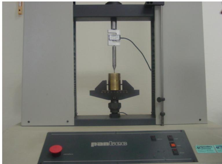
Figura 15 - Máquina utilizado para realização dos ensaios flexão
