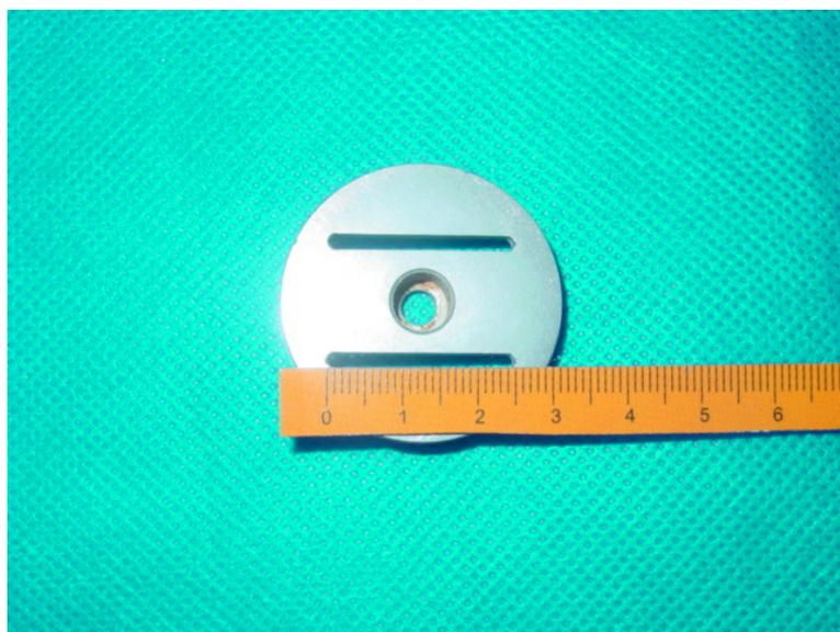
Figura 4 - Matriz utilizada para a confecção dos corpos-de-prova
