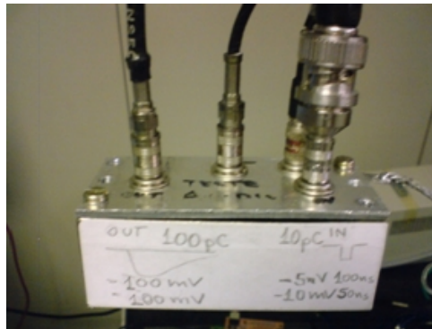
Figura 31: Pré-amplificador utilizado na determinação do ganho pelo método estatístico
