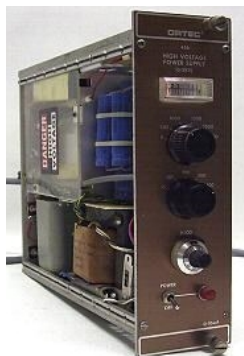
Figura 28: Fonte de alta tensão ORTEC 456
