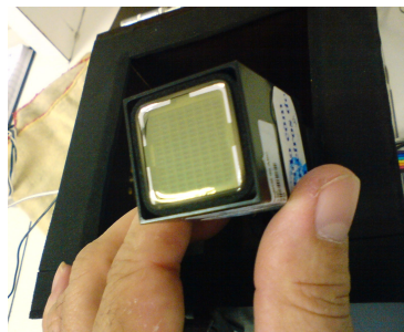
Figura 10: Fotomultiplicadora multianódica H7546B
