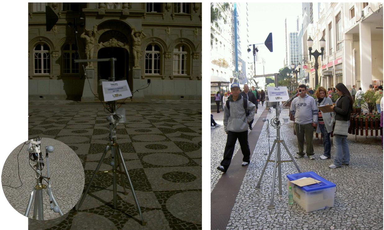
Figura 26 – Estação HOBO (H21-001) e termômetros de globo no detalhe
