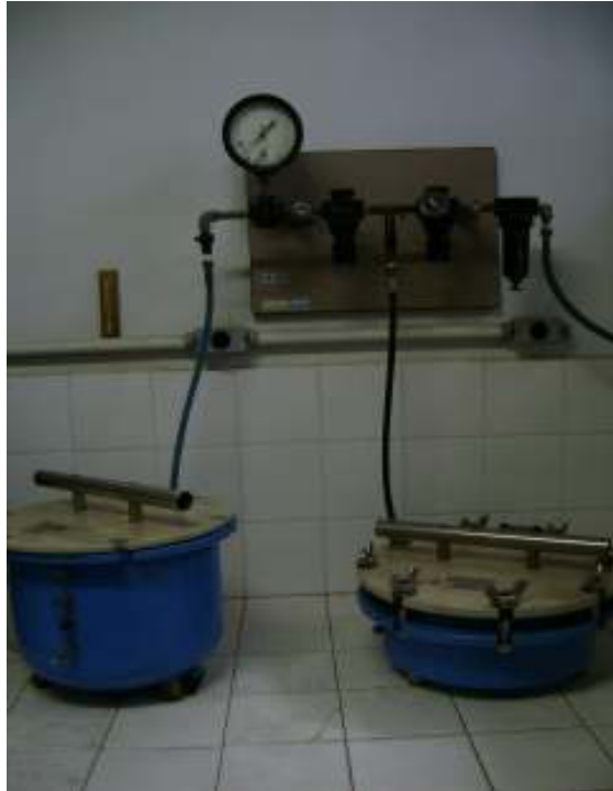
Figura 7: Painéis de alta e baixa pressão de Richards, usadas para drenar a água dos macroporos do solo.
