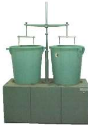
Figura 6: Aparelho de Yoder, utilizado para a determinação da estabilidade dos agregados por via úmida.
