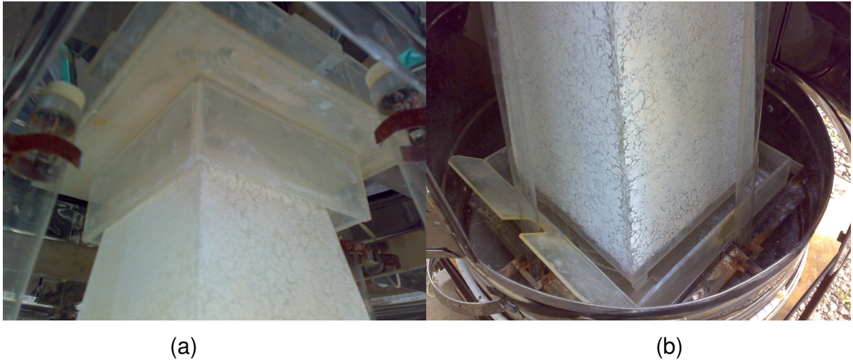
Figura 8: Detalhes internos do FTC : (a) Calha distribuidora superior e (b) base do reator tipo cone
