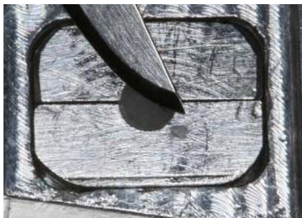
Figura 12 - Remoção dos excessos de resina
