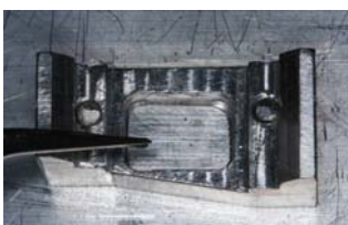
Figura 6 - Matriz metálica + base metálica intermediária + tira de poliéster
