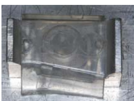
Figura 6 - Matriz metálica + base metálica intermediária + tira de poliéster
