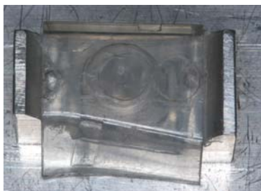
Figura 17 –Segmento de moldeira com silicone incolor posicionado sobre a matriz metálica
