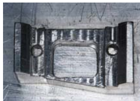
Figura 5 - Matriz metálica + base metálica intermediária
