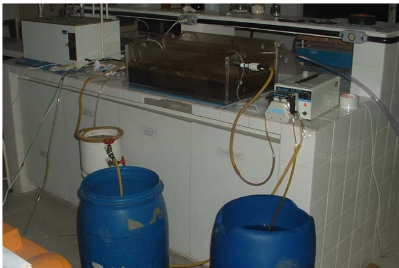
Figura 3.8. Estudo do processo de lodos ativados em unidade piloto.
