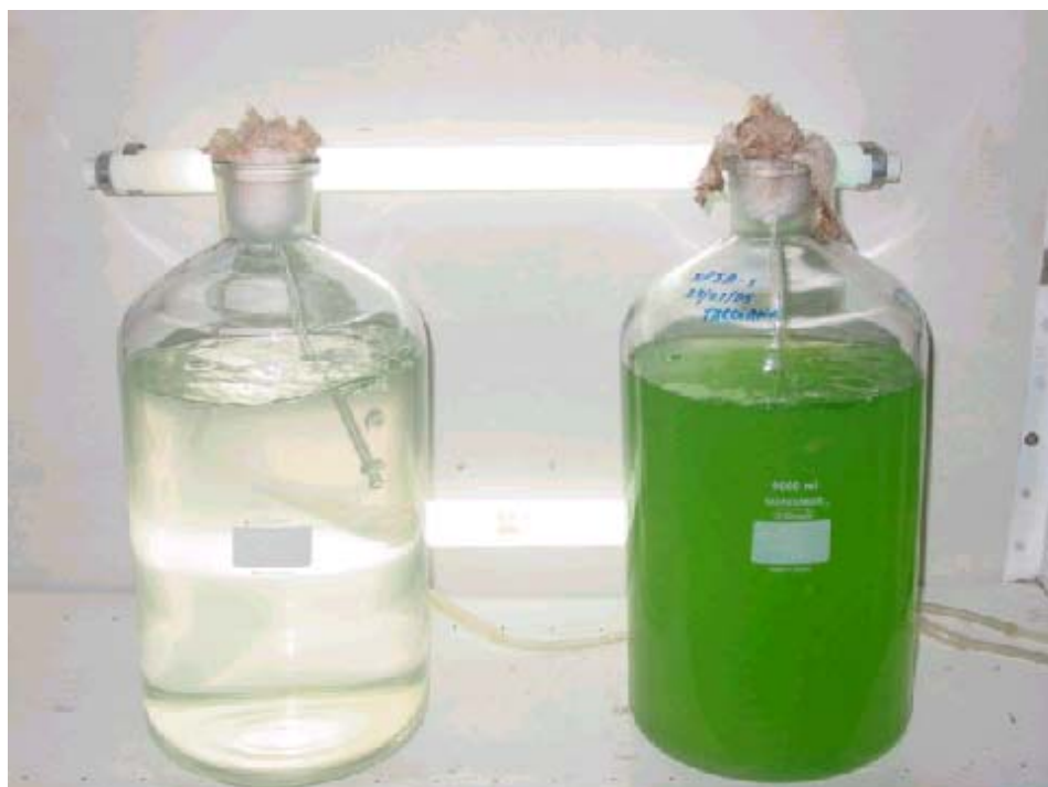
Figura 4.1: Balão de Mariot imediatamente inoculado (à esquerda) e após 08 dias de cultivo (à direita)
