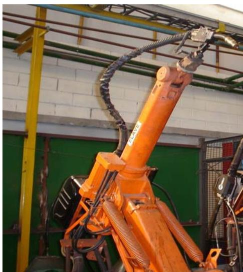
Figura 32 - Processo "GMAW" robotizado (TSH, 2005)
