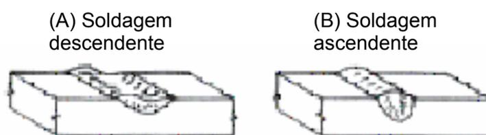
Figura 6 - Efeito da inclinação de trabalho na forma do cordão de solda (BRACARENSE, 2003)
