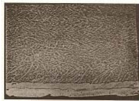
Figura 31 - Macrografia de uma junta soldada (COLPAERT, 1974)
