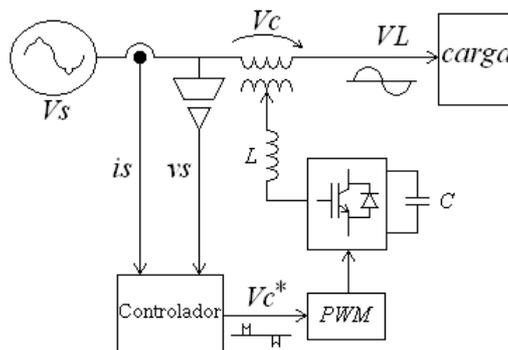
Fig. 2.14 – Diagrama simplificado de um FAS
