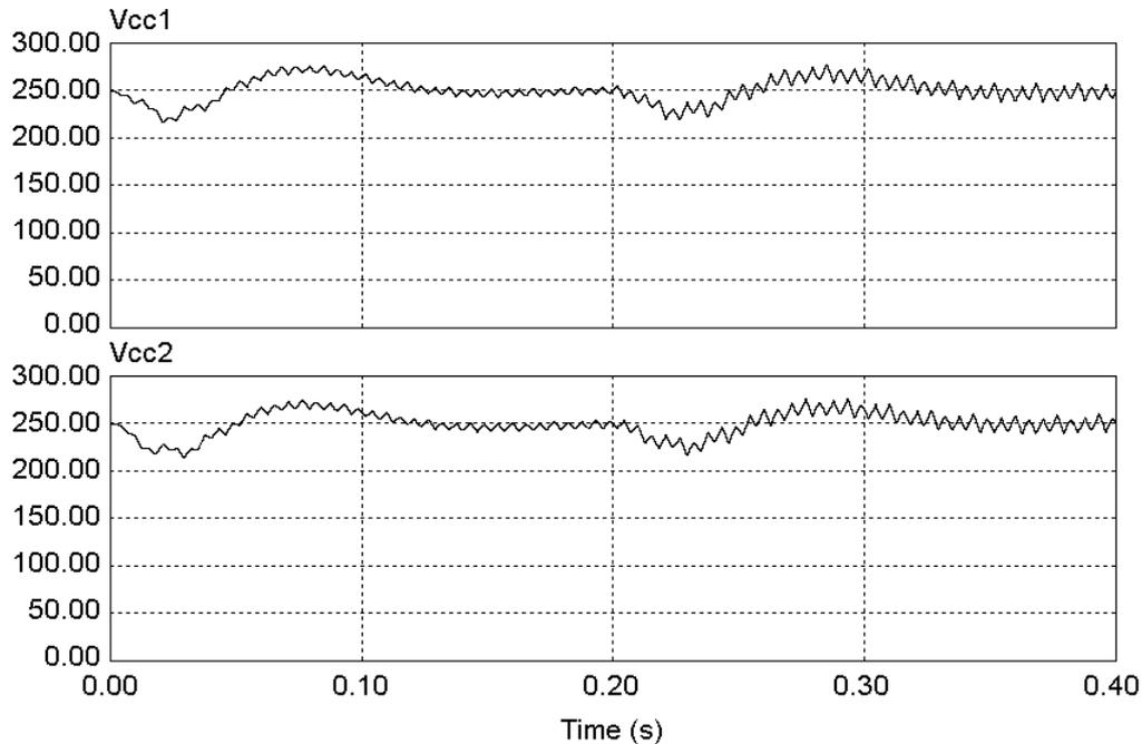
Fig. 5.14 – Tensão barramento CC do FAP topologia *Split-Capacitor* (controle independente) - (situação 1)
