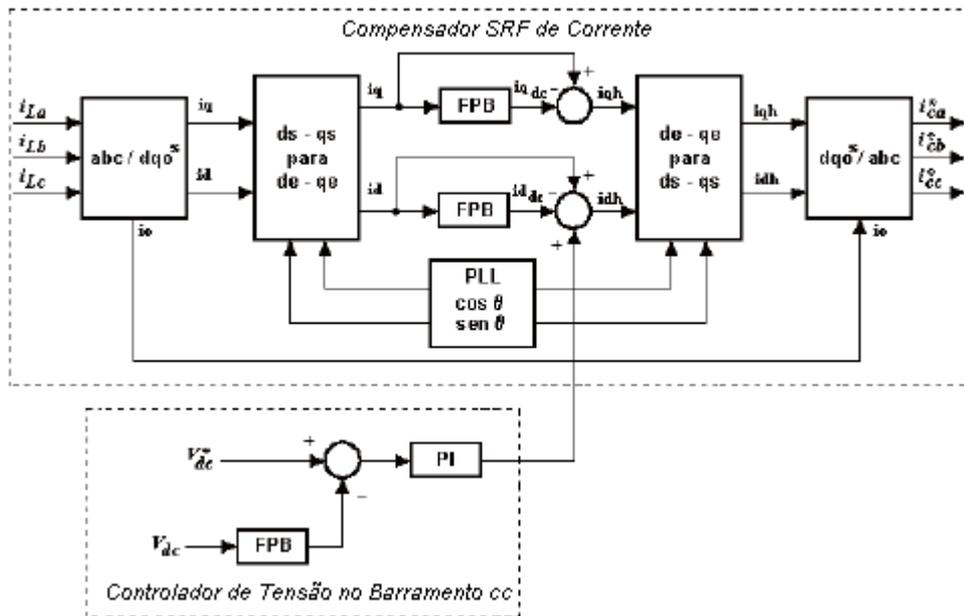
Fig.3.9 – Diagrama de blocos de um compensador SRF
