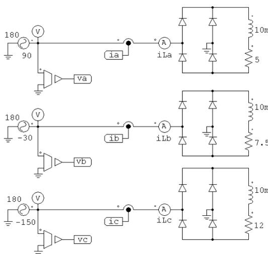
Fig. 3.5 – Circuito trifásico contendo cargas monofásicas desbalanceadas
