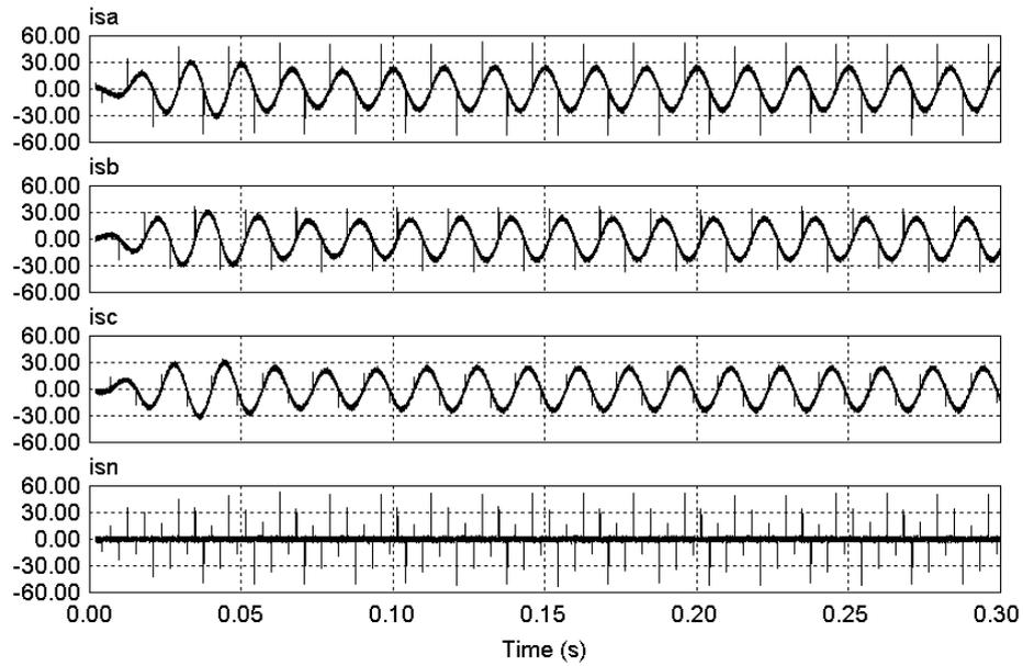
Fig. 5.25 – FAP topologia *Four-Legs* (com compensação de cargas desbalanceadas) – correntes *isa*, *isb*, *isc*, *isn* compensadas (situação 2).
