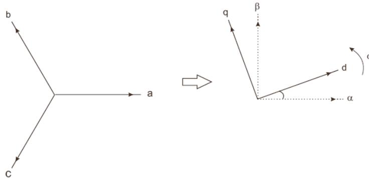
Fig. 3.8 - Transformação referência *a-b-c* para *d-q*
