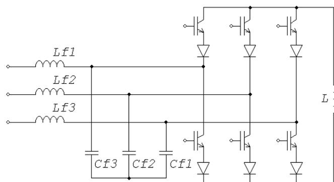
Fig. 2.20 – Conversor fonte de corrente (CSI)
