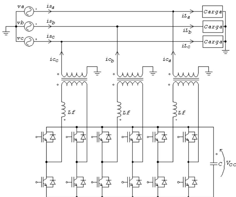
Fig. 4.8 – Filtro ativo paralelo topologia *Three Full-Bridge*
