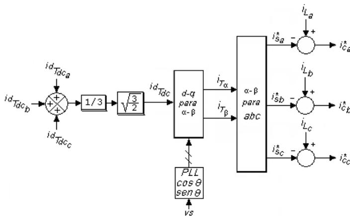
Fig. 5.2 – Algoritmo de compensação para cargas desbalanceadas
