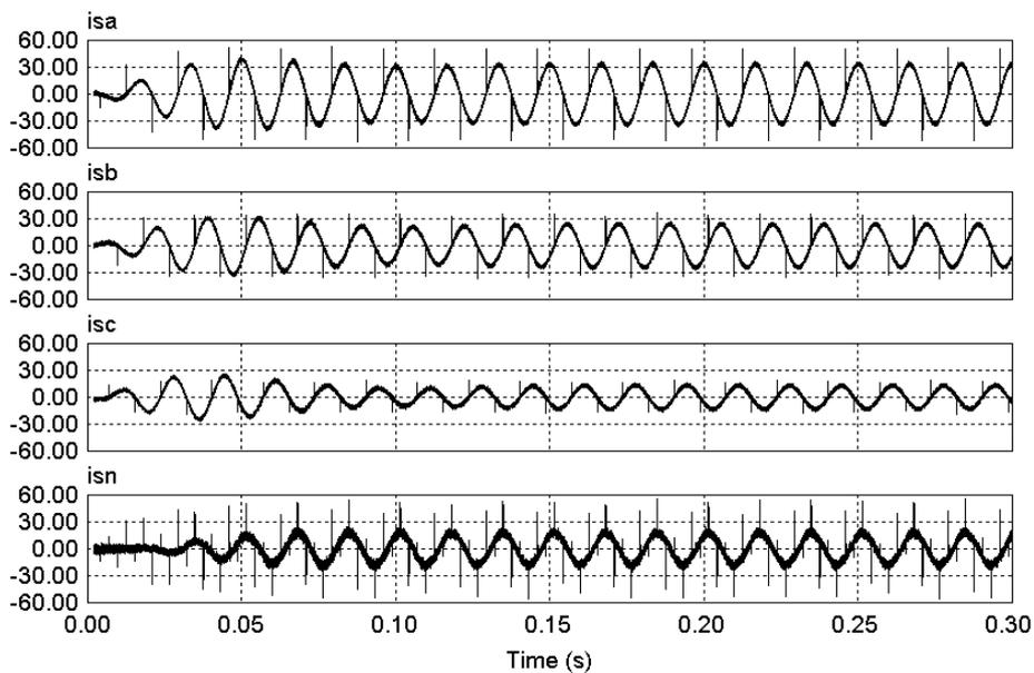
Fig. 5.29 – FAP topologia *Three Full-Bridge* (controle independente) – correntes  $isa$ ,  $isb$ ,  $isc$ ,  $isn$  compensadas (situação 1).
