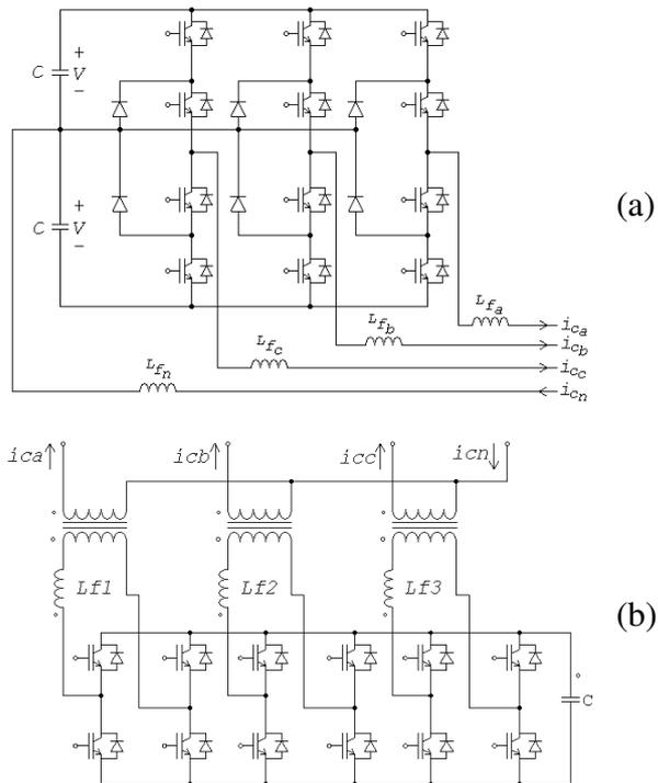
Fig. 2.22 – Topologias de Filtros Ativos Paralelos: (a) *Inversor NPC trifásico*, (b) *Three Full-Bridge*
