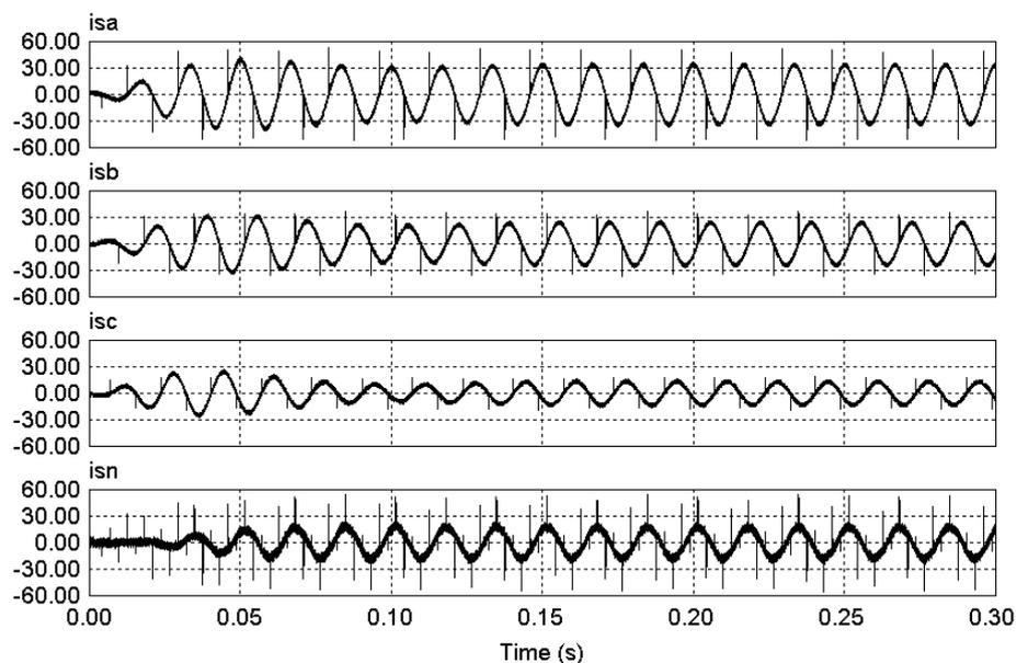
Fig. 5.13 – FAP topologia *Split-Capacitor* (controle independente) – correntes *isa*, *isb*, *isc*, *isn* compensadas (situação 1).
