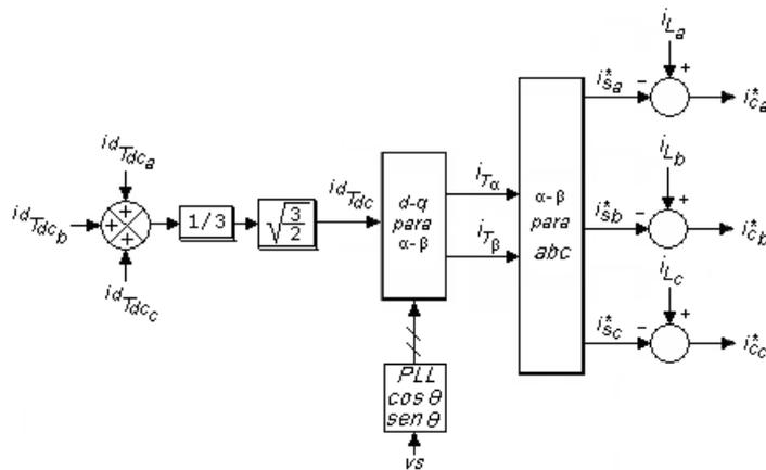
Fig. 4.3 – Algoritmo de compensação para cargas desbalanceadas
