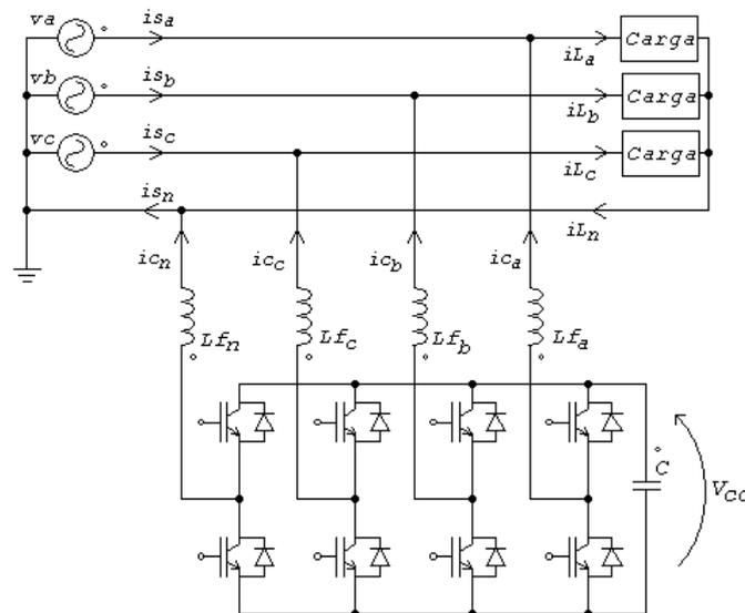
Fig. 4.5 - Filtro Ativo Paralelo topologia *Four-Legs*4.2.2.1 Algoritmos de compensação de corrente do *FAP* baseado na topologia *Four-Legs* - (Sistema 2)
