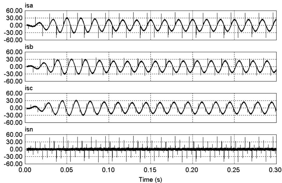
Fig. 5.17 – FAP topologia *Split-Capacitor* (com compensação de cargas desbalanceadas) – correntes *isa*, *isb*, *isc*, *isn* compensadas (situação 2).
