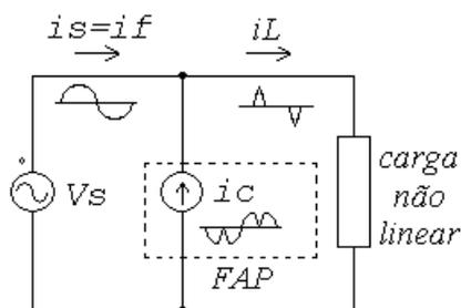
Fig. 2.16 – Princípio de funcionamento do FAP
