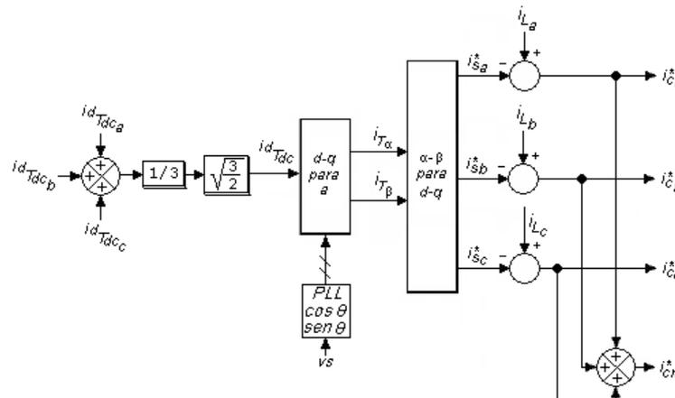
Fig. 5.5 – Algoritmo de compensação para cargas desbalanceadas (topologia *Four-Legs*)
