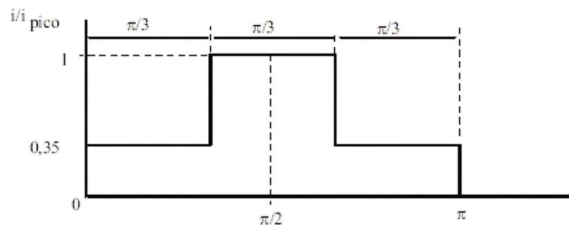
Fig. 2.3 - Envelope da corrente de entrada que definia um equipamento como classe D
