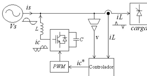
Fig. 2.17 – Diagrama simplificado de um FAP
