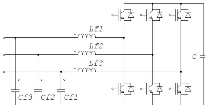
Fig. 2.19 – Conversor fonte de tensão (VSI)
