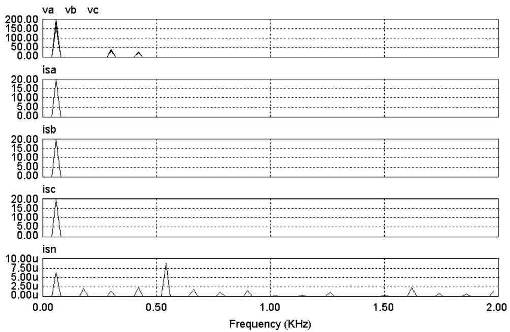
Fig. 3.29 – Espectro harmônicos simulação método de compensação *SRF*
