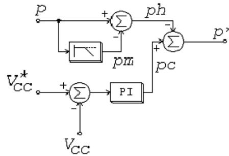
Fig. 3.7 – Diagrama de bloco do controlador PI de tensão do barramento CC, (método  $p-q$ ).
