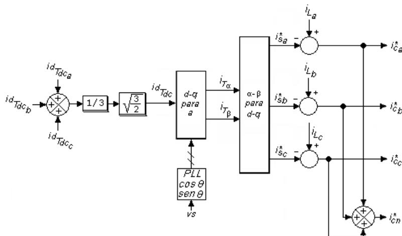
Fig. 4.7 – Algoritmo de compensação para cargas desbalanceadas (topologia *Four-Legs*)
