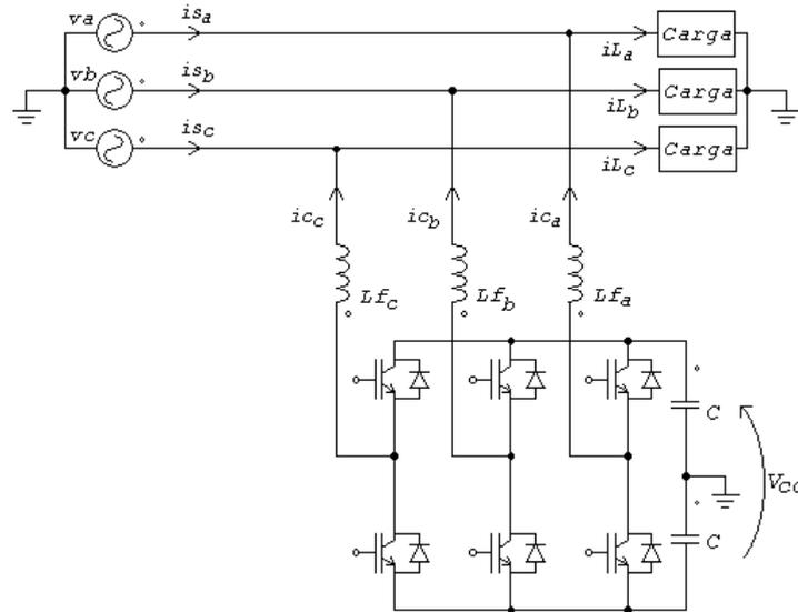
Fig. 4.1 –Filtro Ativo Paralelo topologia *Split-Capacitor*
