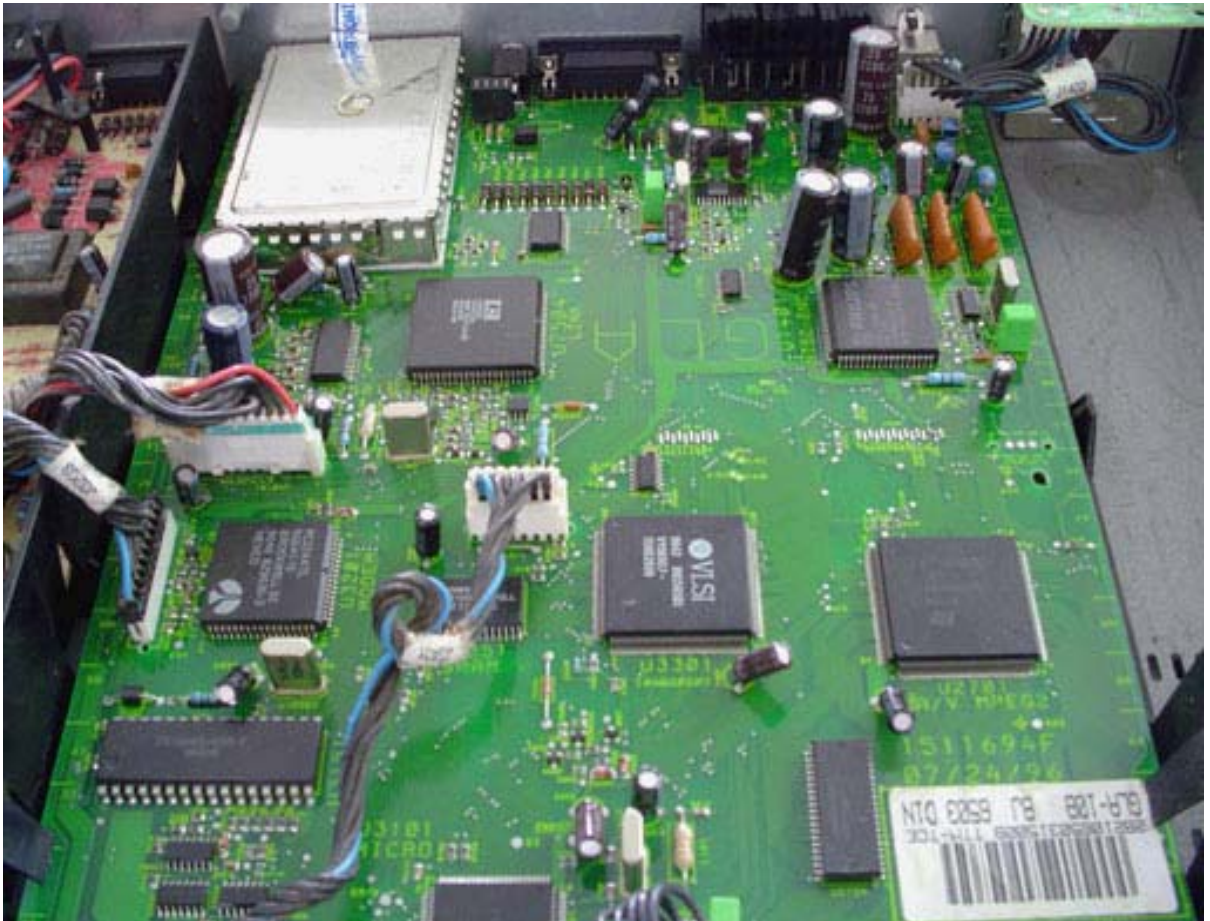
Figura 16 – Foto placa do modelo de decodificador GLA-01 com a aplicação da resina de proteção
