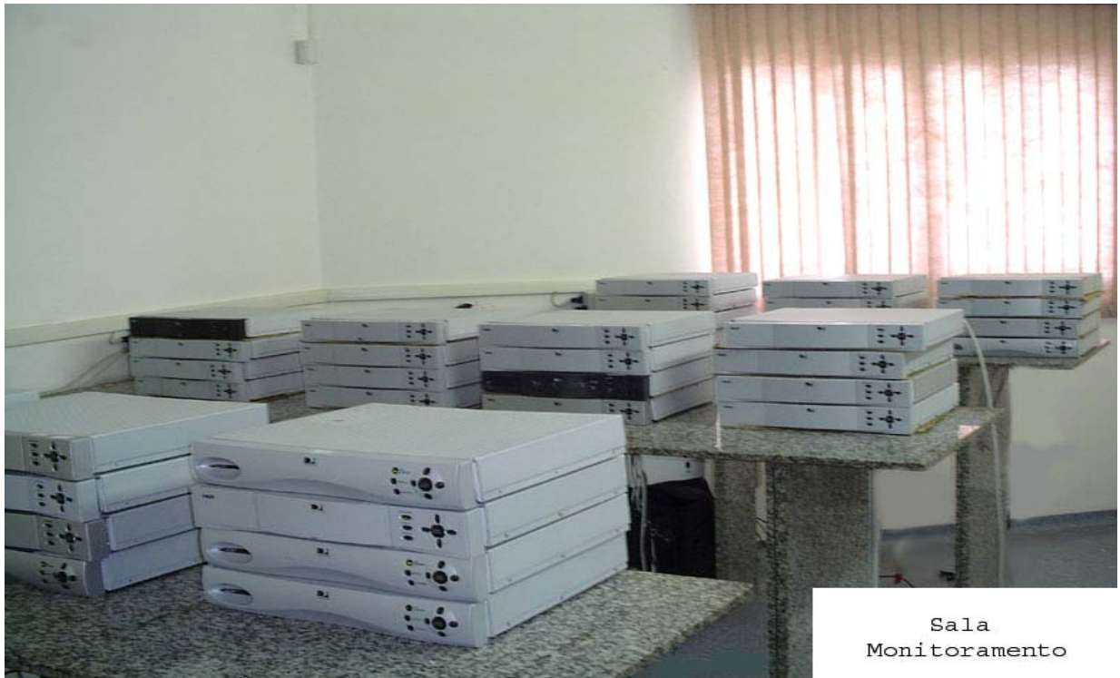
Figura 18 – Disposição dos equipamentos para teste no Burnin Monitorado
