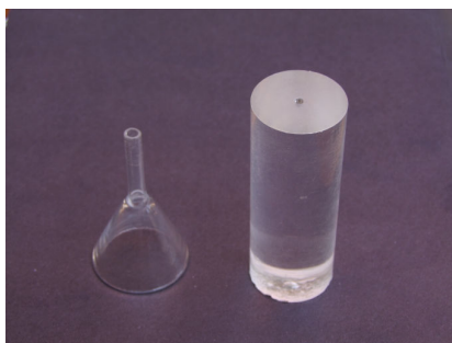
Figura 14. Bastão de lucite utilizado como padrão para a quantidade de massa de amostra utilizada para a leitura TL e, funil utilizado para colocar a amostra na ‘panelinha’ do aparelho leitor TL.
