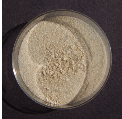
Figura 15. Grãos de quartzo sobre placa de petri durante irradiação por luz solar.
