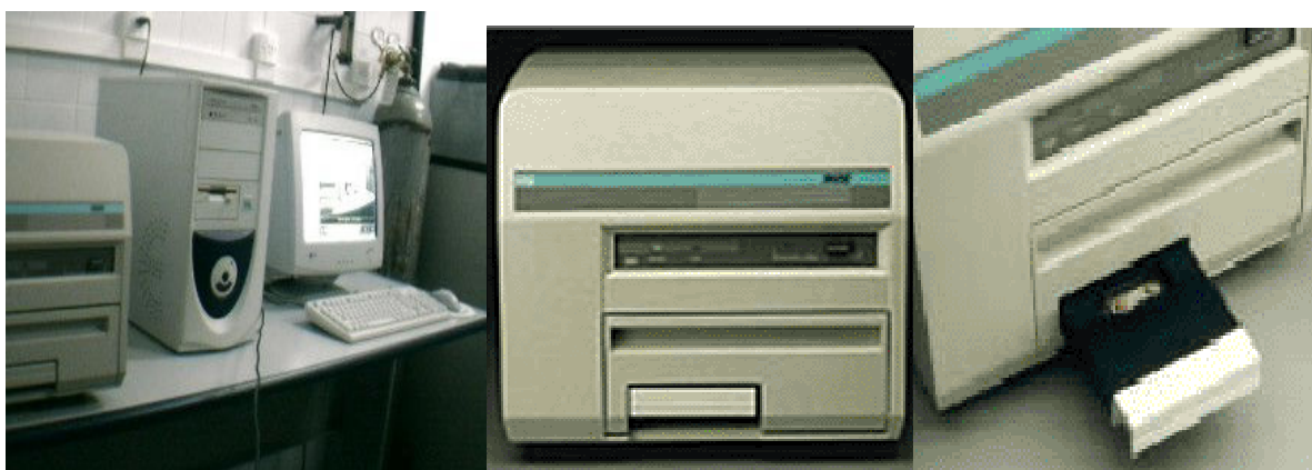
Figura 12. Leitor comercial TL da marca Harshaw série 3500 do laboratório de datação arqueológica do departamento de Física e Química da UNESP de Ilha Solteira.
