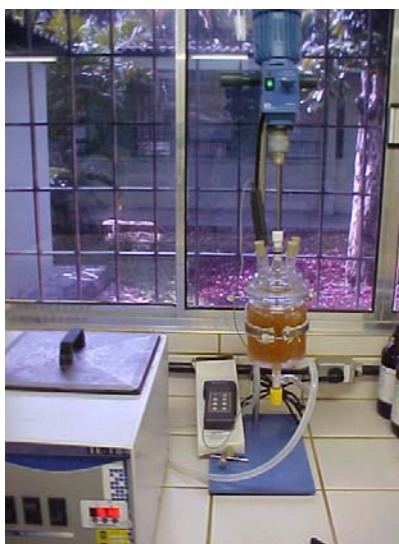
Figura 3.1.1 – (a) Reator homogêneo de laboratório e (b) Dimensionamento do reator.
