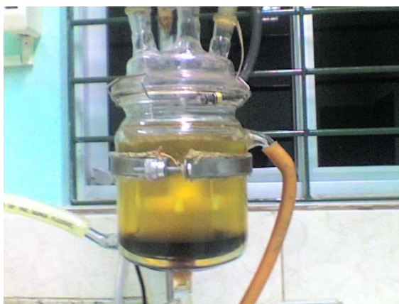
Figura 4.1.4 – Produtos de uma reação de transesterificação do óleo de algodão
