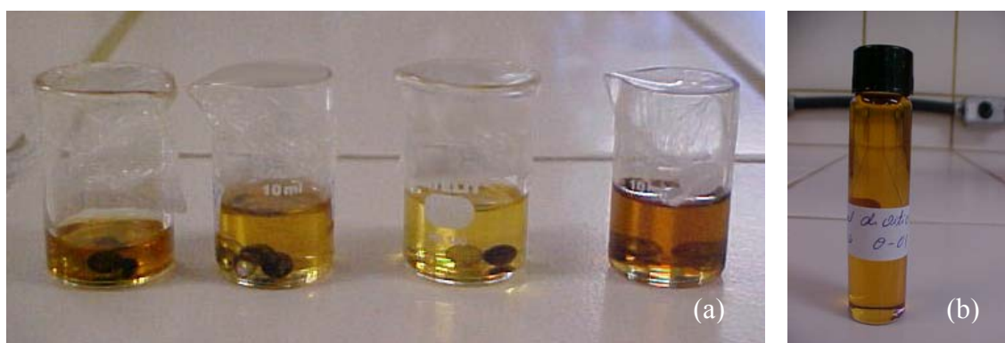
Figura 4.1.1 – (a) Amostras de óleo e (b) de biodiesel de oiticica.
