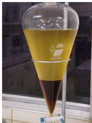
Figura 3.2.1 – Separação das fases glicerina e biodiesel.
