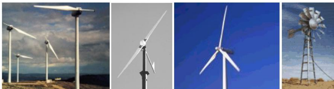
Figura 1.15 – Diversos tipos de turbinas eólicas, com número de pás variável. Fonte: EOLE, 2006.
