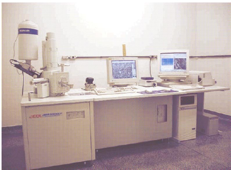
Figura 3.5 – Fotografia do microscópio eletrônico de varredura (MEV) do LNLS, equipado com sistema de fluorescência de raios X por dispersão em energia.
