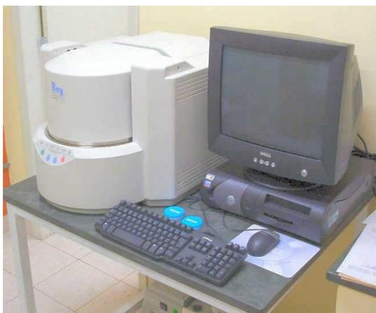
Figura 3.1 – Equipamento Shimadzu EDX-700HS utilizado no desenvolvimento do trabalho.
