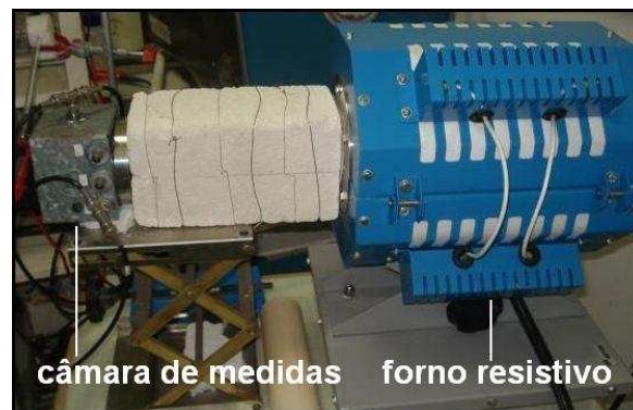
Figura 3.6: Câmara de medidas inserida em forno resistivo.
