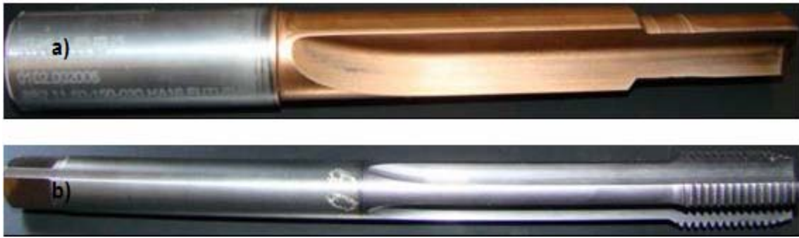
Figura 3.10 – Ferramentas utilizadas nos ensaios de rosqueamento de ferro fundido vermicular; a) broca escalonada; b) macho de corte M13 X 1,5mm
