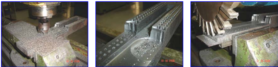
Figura 3.18 – Imagens das etapas de preparação da chapa escalonada utilizada nos testes para investigar a influência da espessura de corte no rosqueamento com machos de corte
