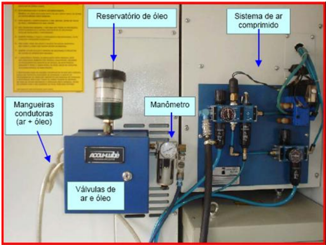
Figura 3.15 – Equipamento de mínima quantidade de fluido (MQF) acoplado na máquina CNC
