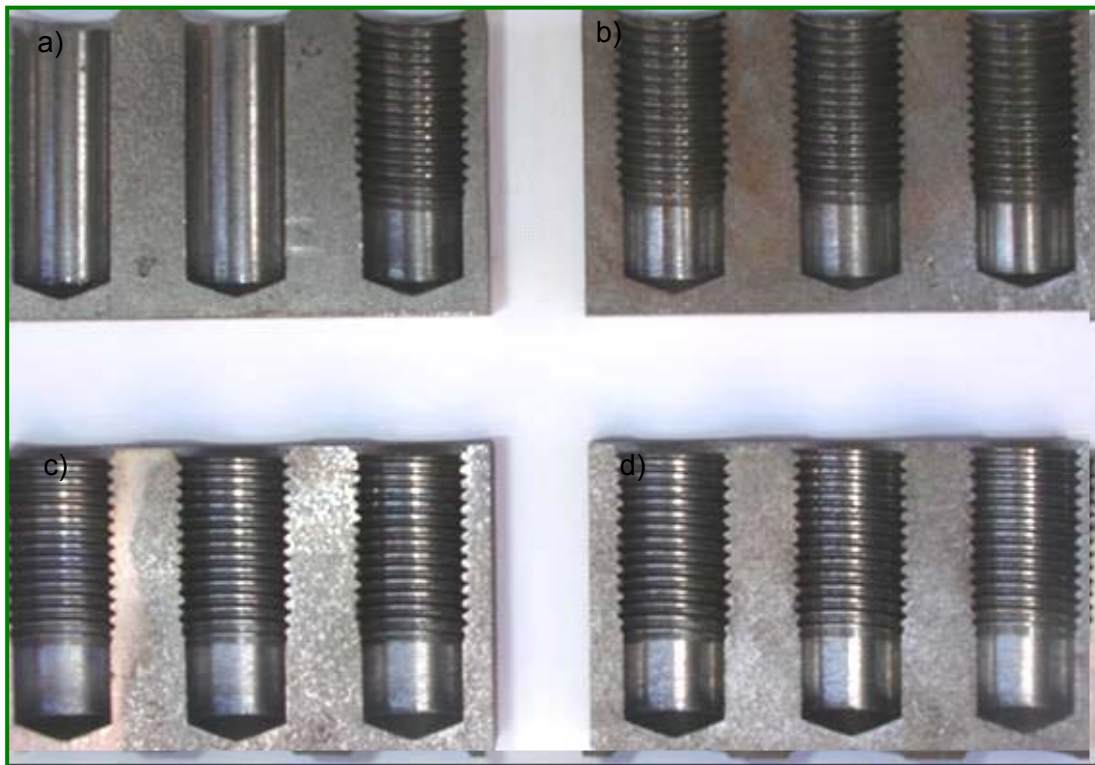
Figura 3.16 – Exemplos de corpos de prova para observação no MEV; a) rosqueamento com velocidade de corte de 5 m/min; b) velocidade de corte igual a 25 m/min; c) velocidade de corte de 50 m/min; d) velocidade de corte de 100 m/min
