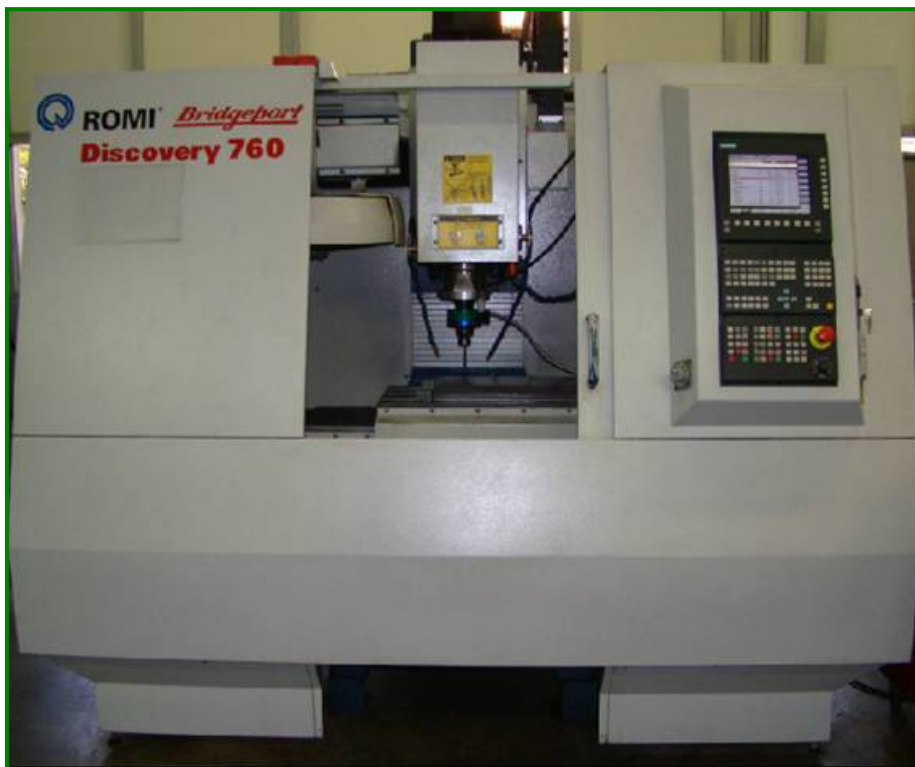
Figura 3.8 – Centro de usinagem vertical, modelo Discovery 760 (ROMI), utilizada nos testes de laboratório
