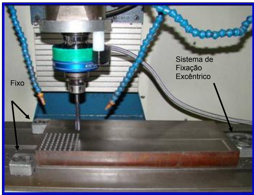
Figura 3.9 – Sistema de fixação dos corpos de prova (placas de CGI)
