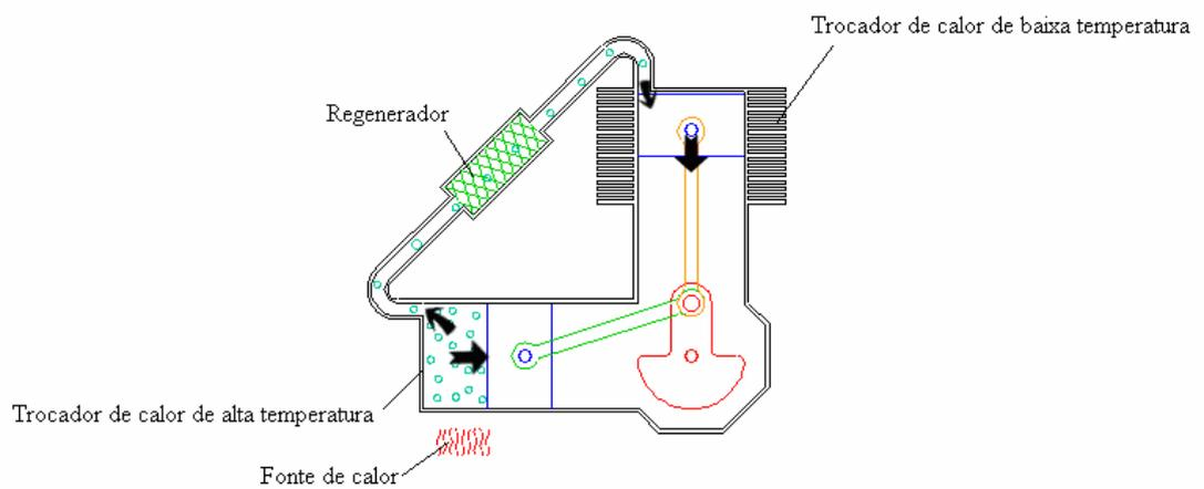
Fig. 17 – Funcionamento do motor na configuração Alfa (KEVENEY, 2006)
