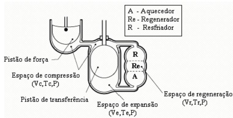
Fig. 26 – Modelo de motor Stirling configuração Gama (HIRATA, 1997)
