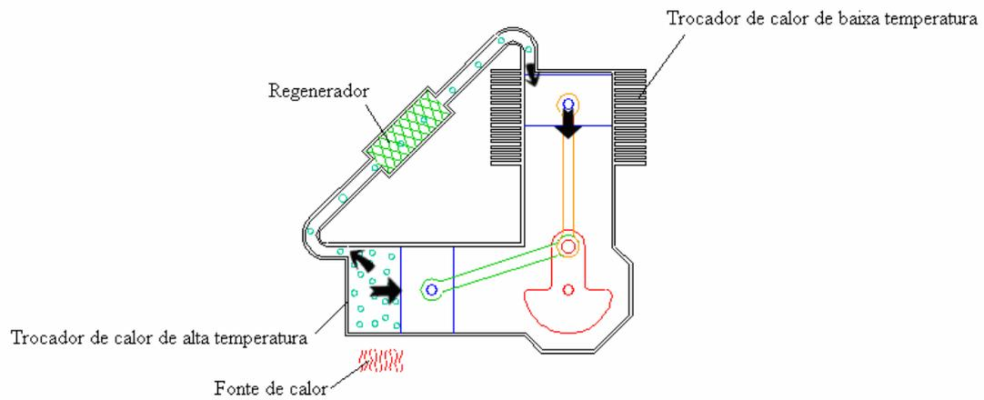
Fig. 13 – Processo de expansão do gás (KEVENEY, 2006)
