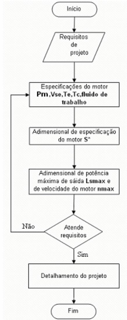
Fig.27 – Fluxograma de processo para projeto de motores Stirling (HIRATA, 1998)
