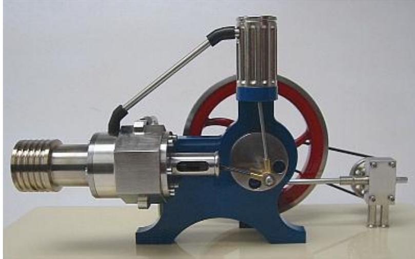
Fig. 16 – Configuração Alfa de motor Stirling (HOWELL, 2006)
