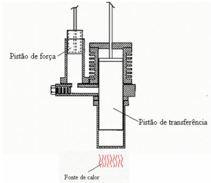
Fig. 21 – Funcionamento do motor na configuração Gama (STIRLING, 2006)
