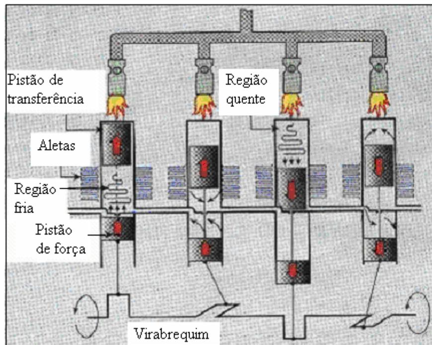
Fig. 32 – Funcionamento do motor Stirling referência de projeto (STEELE, 1994)
