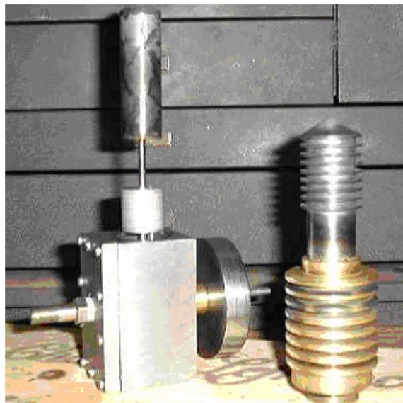
Fig. 18 – Motor Stirling configuração Beta (SYMANSKI, 2006)
