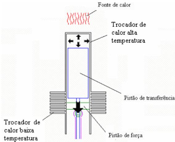
Fig. 19 – Funcionamento do motor na configuração Beta (KEVENEY, 2006)
