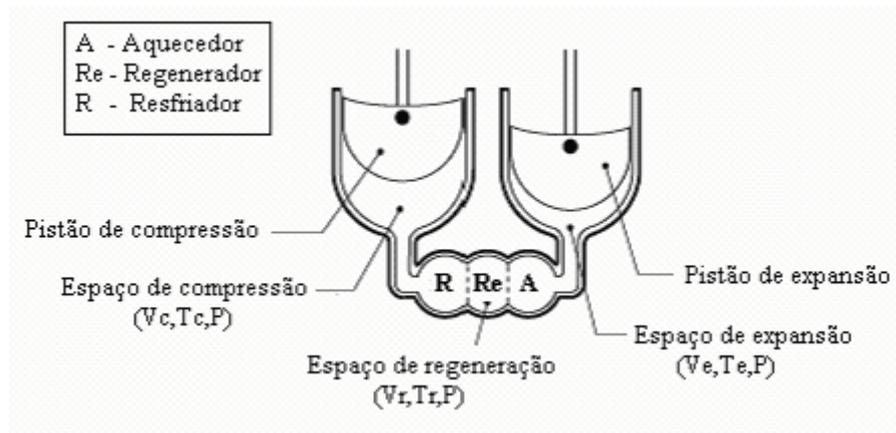
Fig. 24 – Modelo de motor Stirling configuração Alfa (HIRATA, 1997)
