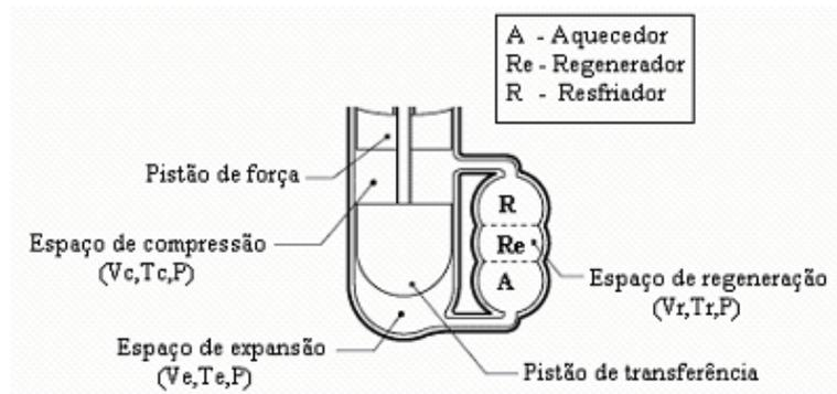
Fig. 25 – Modelo de motor Stirling configuração Beta (HIRATA, 1997)
