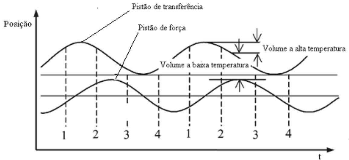
Fig. 15 – Diagrama movimento senoidal ideal motor Stirling, configuração Gama (KONGTRAGOOL, 2003)
