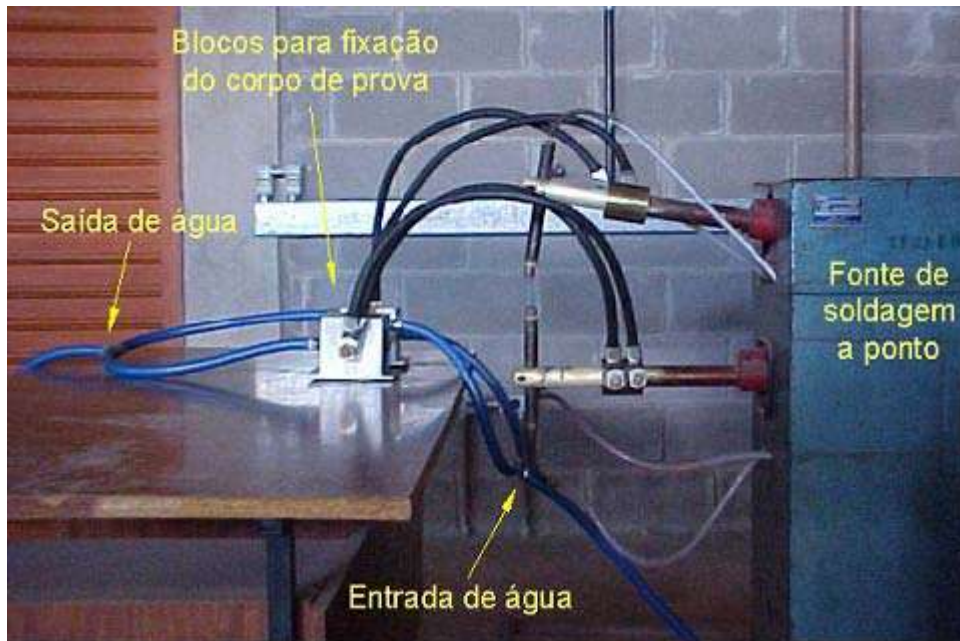
Figura 9.2 – Esquema de montagem do simulador térmico
