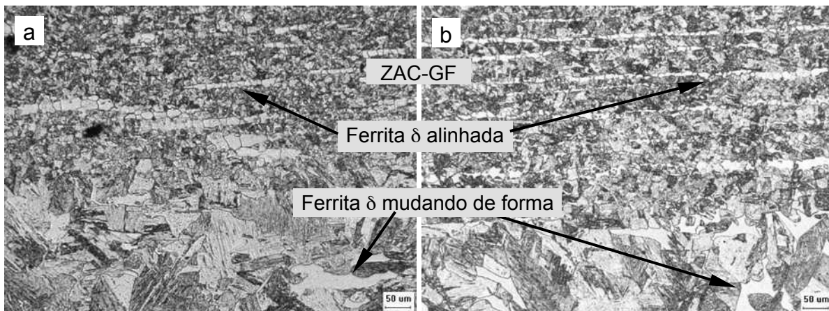
Figura 7.13 – Interface entre a ZAC de grão grosseiro e ZAC de grão fino. Solda realizada em material tratado em forno contínuo soldado com baixa energia.
