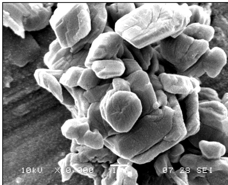
Figura 4.9 - Micrografia do catalisador de Mo não calcinado com ampliação de 10000 vezes
