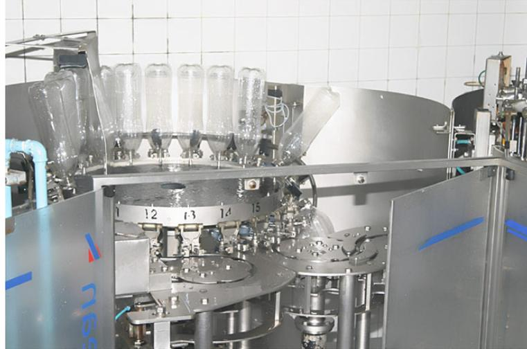
Figura 3 – Máquina de envasamento de refrigerante (cortesia: IRL)
