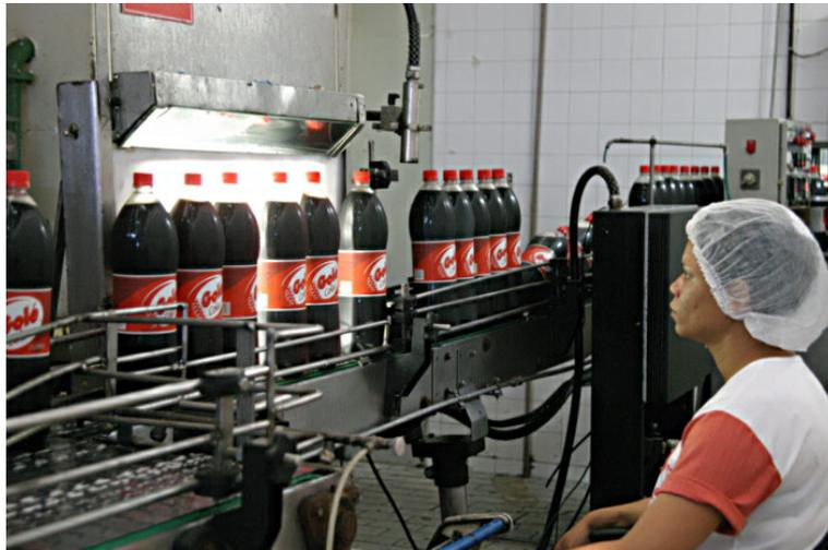
Figura 5 – Funcionária realizando inspeção visual (cortesia: IRL)
