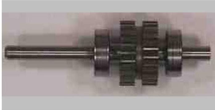
Figura 8 – Rotor com pólos e imãs acoplados
