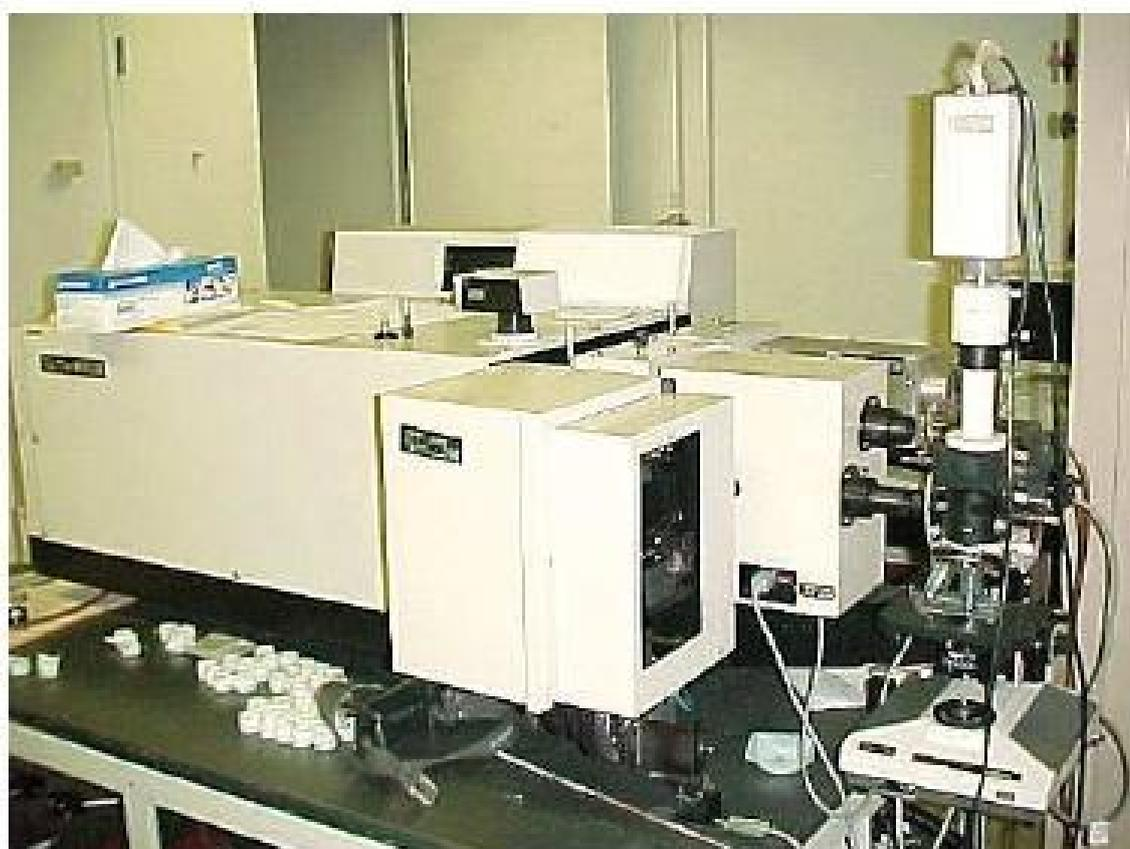
Figura 9: Espectrômetro Raman modelo U-1000 duplo-monocromador.
