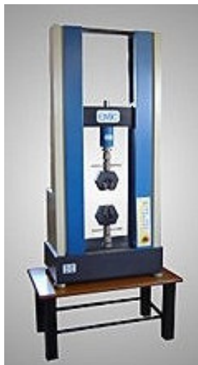
Figura 29 – Máquina universal de ensaios EMIC DL 10000
