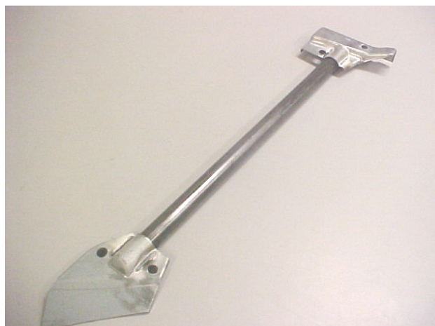
Figura 23 – Barra de proteção lateral tubular acabada
