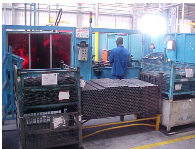
Figura 19 – Célula de montagem da barra de proteção lateral veicular tipo tubular
