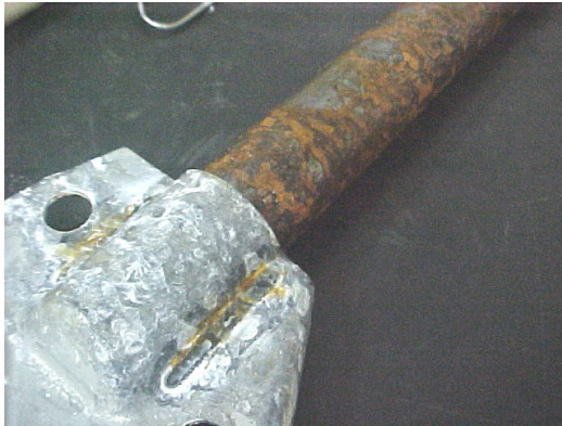
Figura 40 – Peça com corrosão vermelha após 72 horas de salt spray
