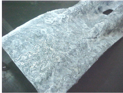
Figura 41 – Peça com corrosão branca após 72 horas de salt spray
