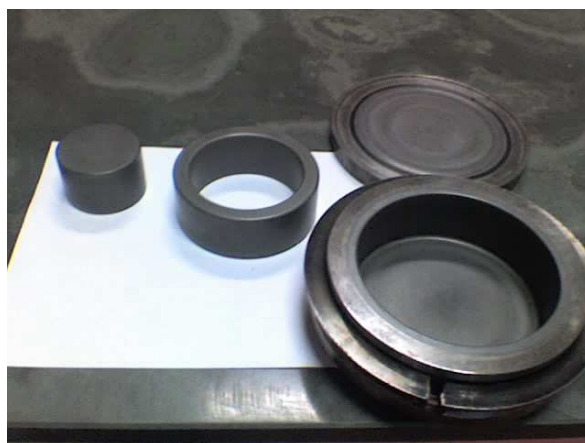
Figura 3.13: Foto dos cilindros e panela (de carbetto de tungstênio) do moinho utilizado.
