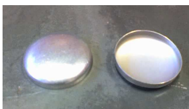
Figura 3.14: Botões de alumínio utilizados para a confecção das amostras analisadas.
