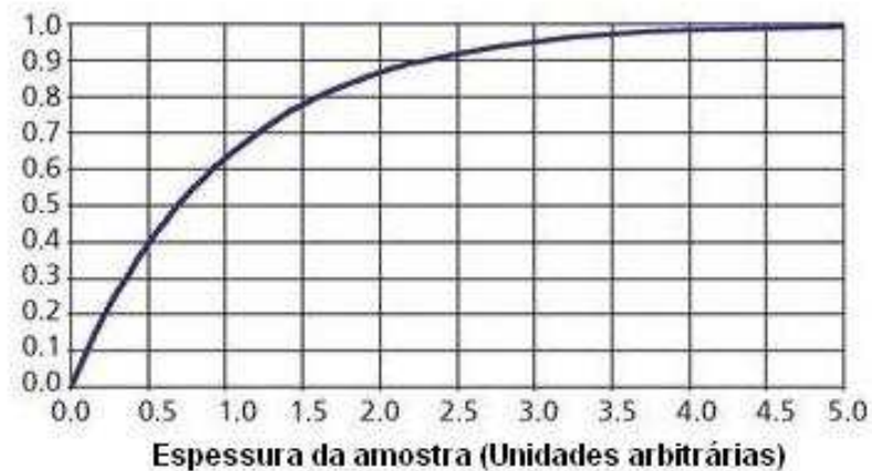
Figura 2.16: Intensidade de uma linha de fluorescência K_\alpha em função da espessura da amostra (em unidades arbitrárias).
