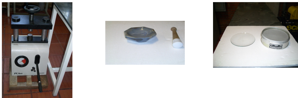
Figura 14: Prensa hidráulica, almofariz de ágata e peneira graduada
