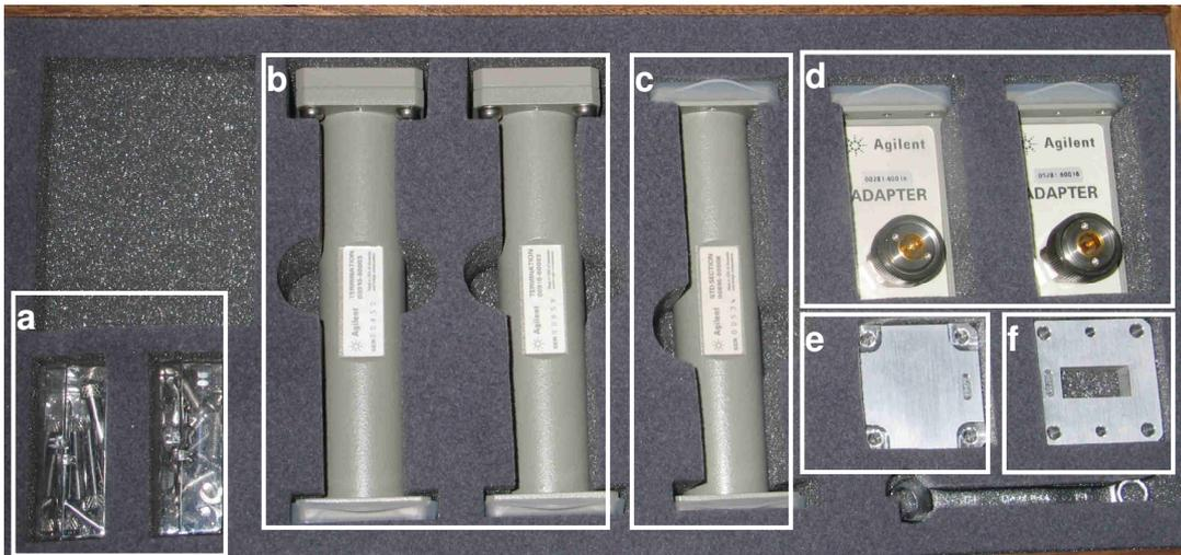
Figura 3.2 – Conjunto de calibração em guia de ondas para a banda X, composto de: (a) parafusos com porcas e parafusos guia, (b) trechos de guia de ondas com atenuador de impedância fixa, (c) trecho de guia de ondas com extremidades abertas, (d) acopladores para conexão do guia de ondas ao cabo coaxial de 3,5mm, (e) placa metálica e (f) porta-amostras ou item usado como atraso, em conjunto da placa metálica [AGILENT TECHNOLOGIES, 2002].
