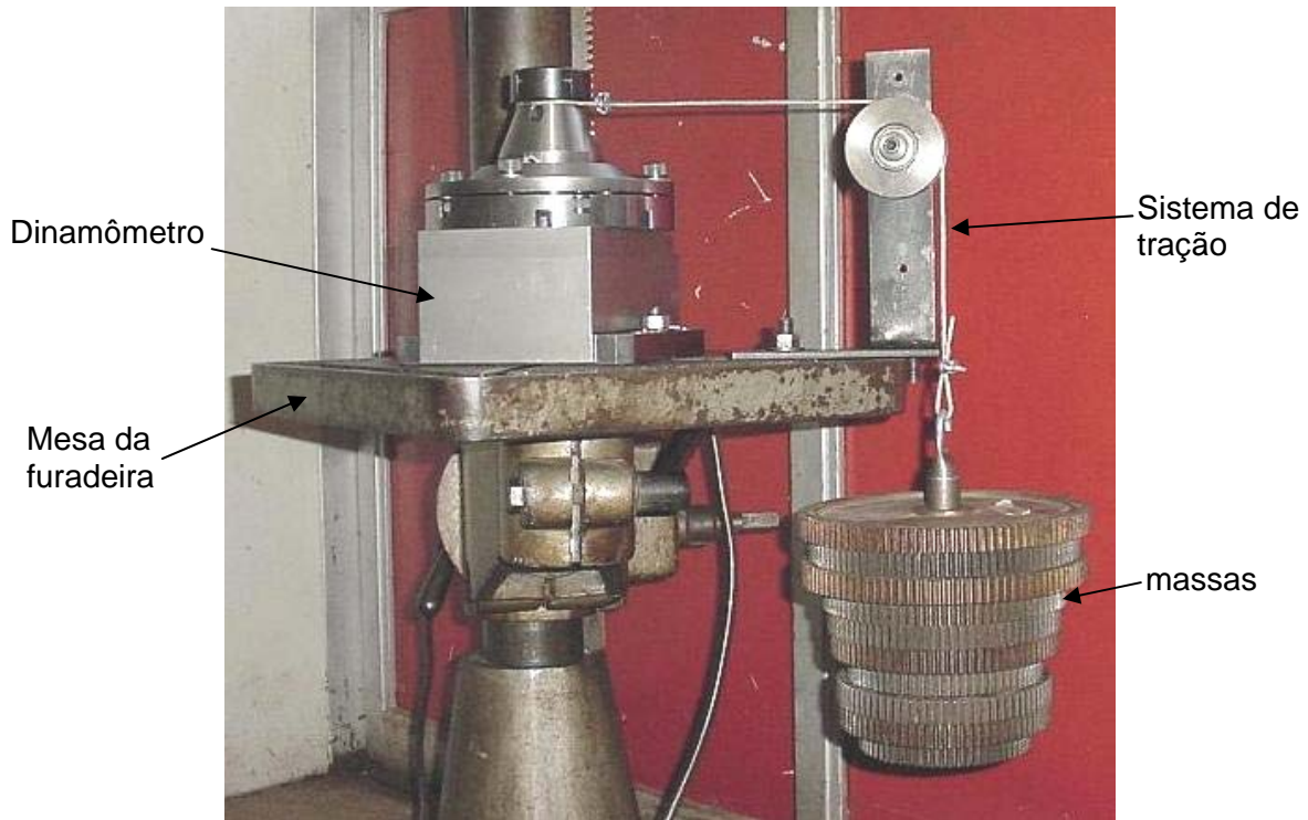
Figura A2.5 – Montagem do sistema de tração para medição de força na direção X ( F_x )
