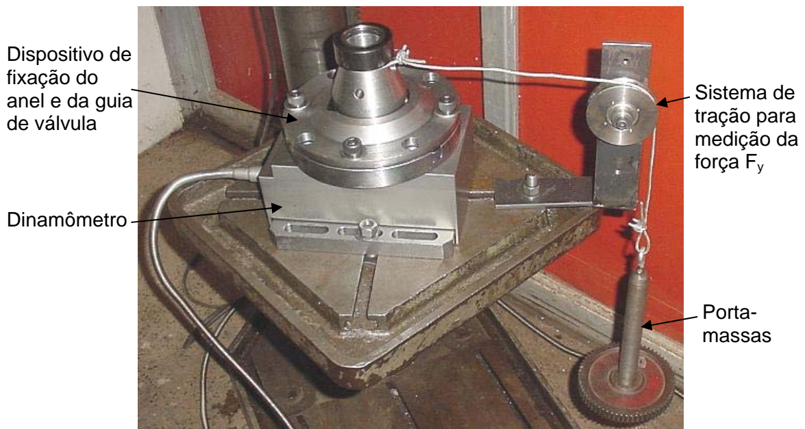
Figura A2.6 – Montagem do sistema de tração para medição de força na direção Y ( F_y )
