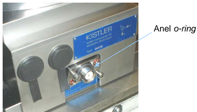
Figura A2.3 - Montagem do anel de borracha o-ring no conector do dinamômetro.
