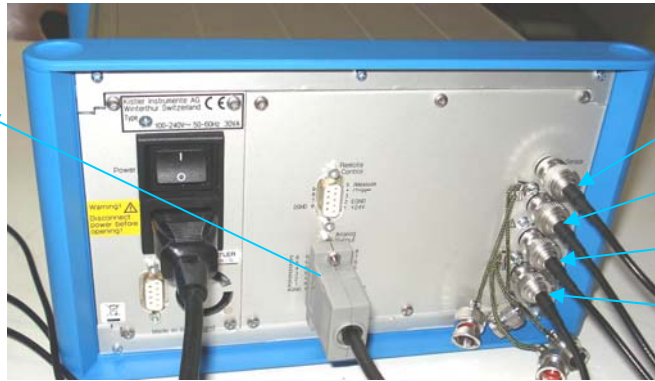
Figura A2.9 – Montagem dos cabos coaxiais BNC no amplificador de carga 5070A
