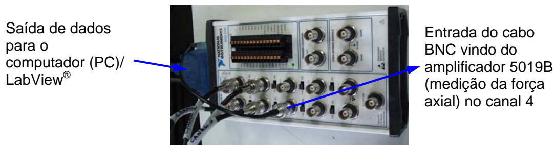
Figura A3.5– Montagem dos cabos BNC no bloco conector de sinais.
