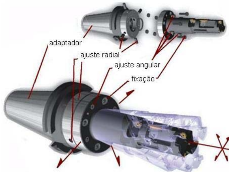
Figura 4.6 – Ferramenta com sistema de ajuste de correção de batimento axial e radial do eixo-árvore da máquina-ferramenta (adaptado HANNA, 2003)
