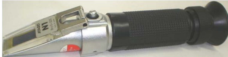
Figura 4.21 – Refratômetro para medição da concentração do fluido de corte
