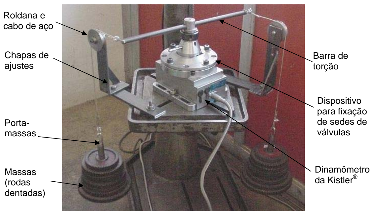
Figura A2.7 - Montagem do dispositivo de torção para medição de torque
