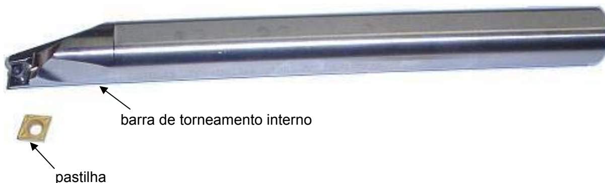
Figura 4.12 – Barra de torneamento interno e pastilha utilizada no torneamento cilíndrico interno dos anéis
