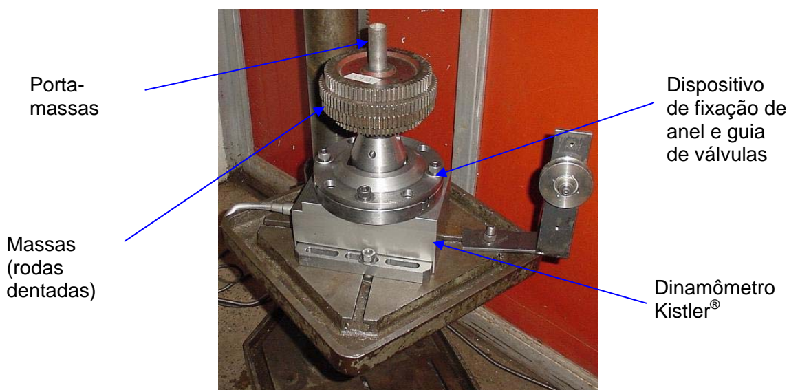
Figura A3.2 - Montagem do sistema para calibração do dinamômetro
