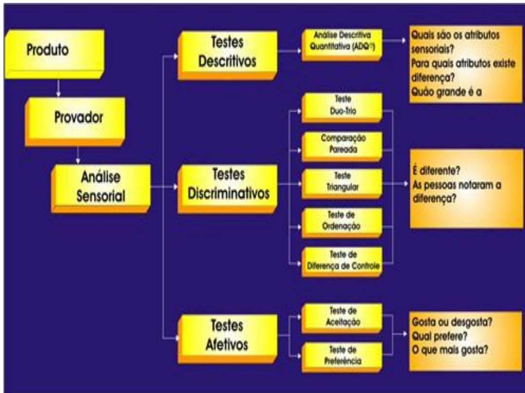
Figura 1- Fluxograma dos Métodos de Análise Sensorial.
