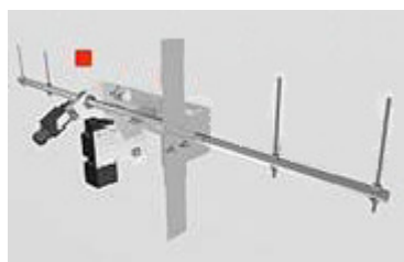
Figura 9 – Contato de cedimento de degrau
