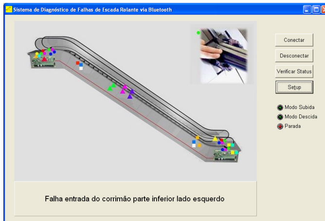
Figura 35 - Falha interpretada pelo sistema de inspeção
