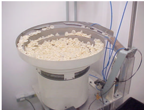
Figura 34 Sistema automático para desenrolar preservativos
