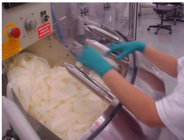
Figura 28 Colocação manual do preservativo no molde
