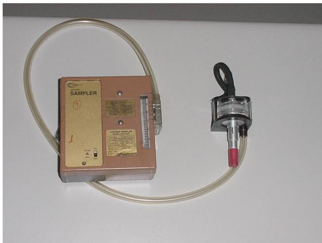
**Figura 4.1.** Fotografia mostrando o amostrador portátil com ciclone utilizado neste estudo para coleta de aerossóis na fração respirável.
