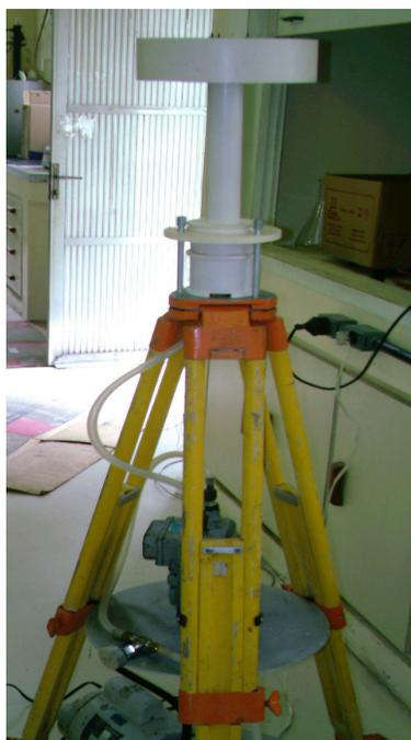
**Figura 4.2.** Fotografia do arranjo experimental na coleta de aerossóis usando o amostrador grosso e fino (AGF).
