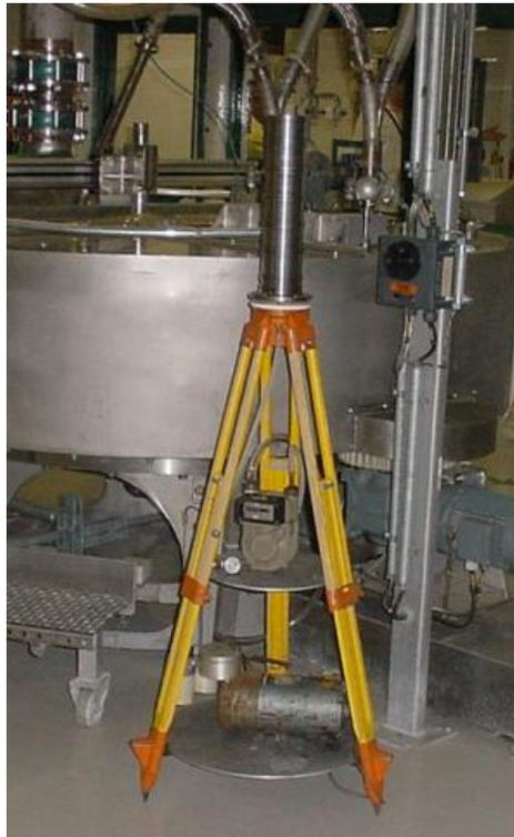
**Figura 4.3.** Fotografia mostrando o arranjo experimental para coleta de aerossóis usando o amostrador do tipo impactador em cascata (IC).
