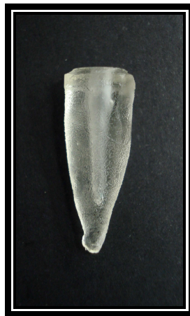
FIGURA 6 – Modelo da raiz em resina fotoelástica
