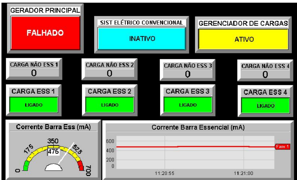
Figura 25 - Gerenciador de Cargas Ativo e G2 Falhado.
