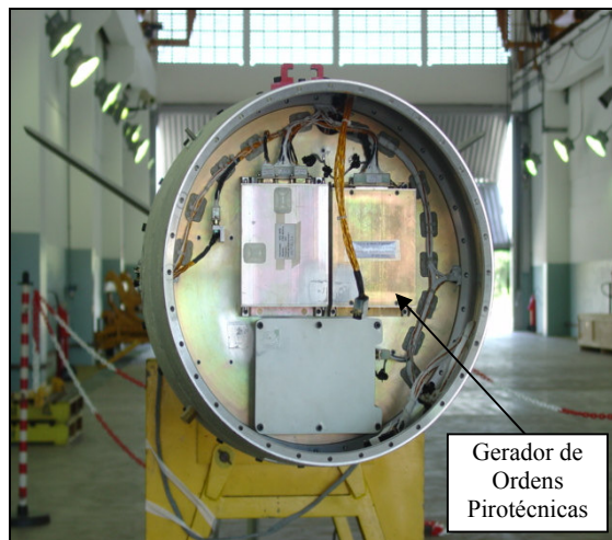
Figura 4 – Vista do Módulo Dianteiro do Segundo Estágio do foguete VSB-30.
