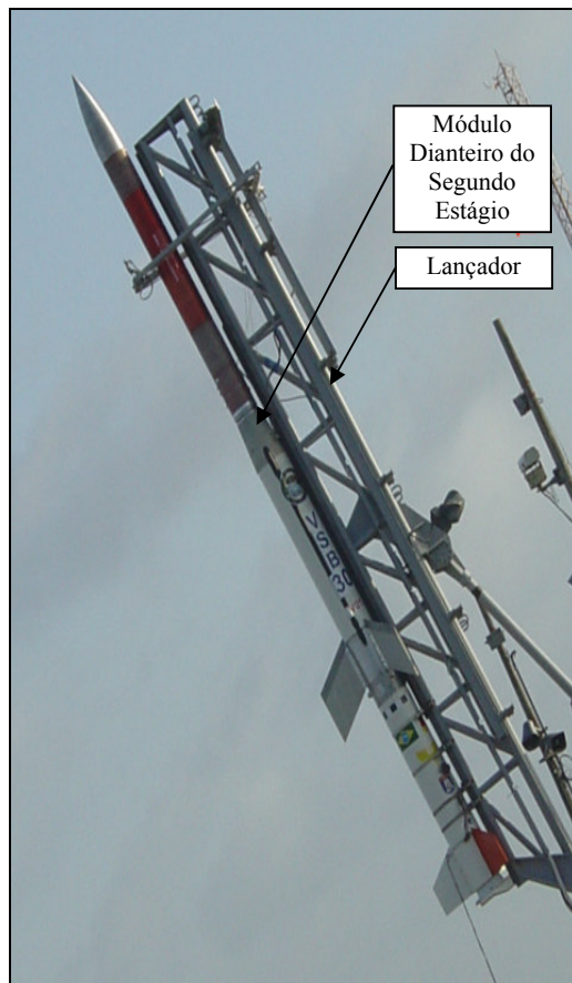
Figura 3 – Fogete VSB-30 integrado no lançador.
