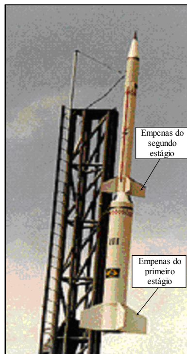
Figura 16 – Empenas instaladas no foguete.
