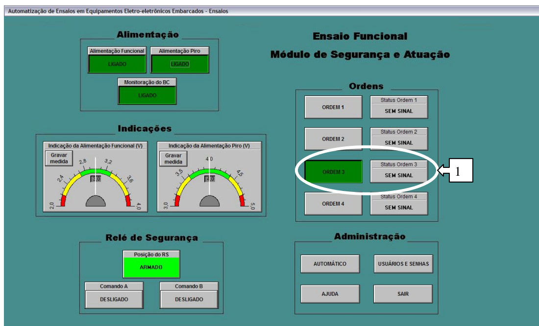
Figura 42 - Identificação de não-conformidade na Ordem 3.
