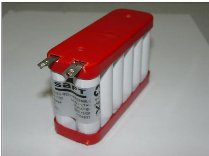
Figura 21 – Bateria para acionamento dos pirotécnicos
