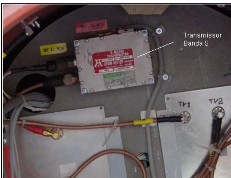
Figura 4 – Transmissor banda S do veículo VSB-30 V01 (ALTENBUCHNER, 2004)
