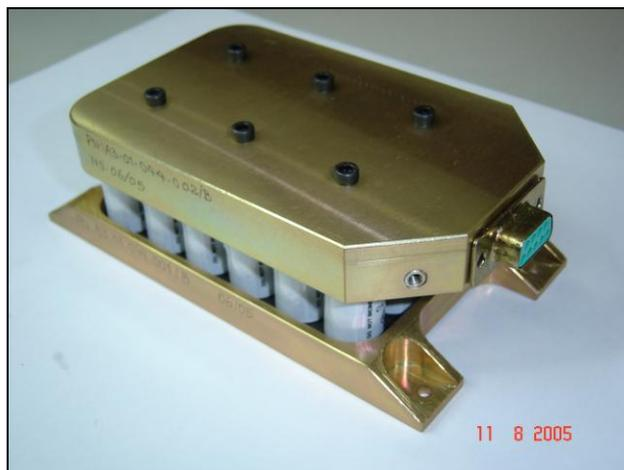
Figura 18 – Bateria de NiCd utilizada em foguetes de sondagem
