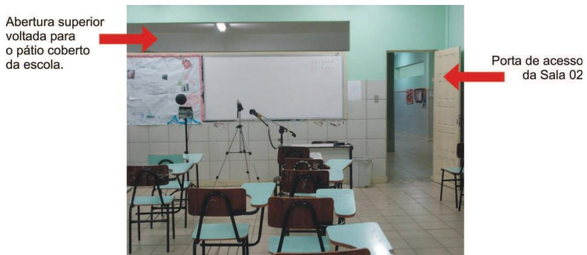
Figura 48 - Vista interna da sala com abertura superior para favorecer a ventilação cruzada.
