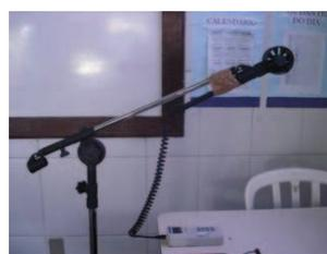
Figura 4 – Medidores da velocidade do ar
