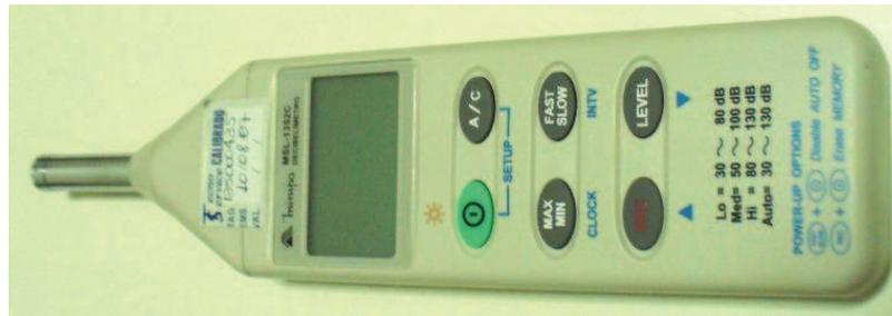
Figura 31 – Medidor de Nível de Pressão Sonora
