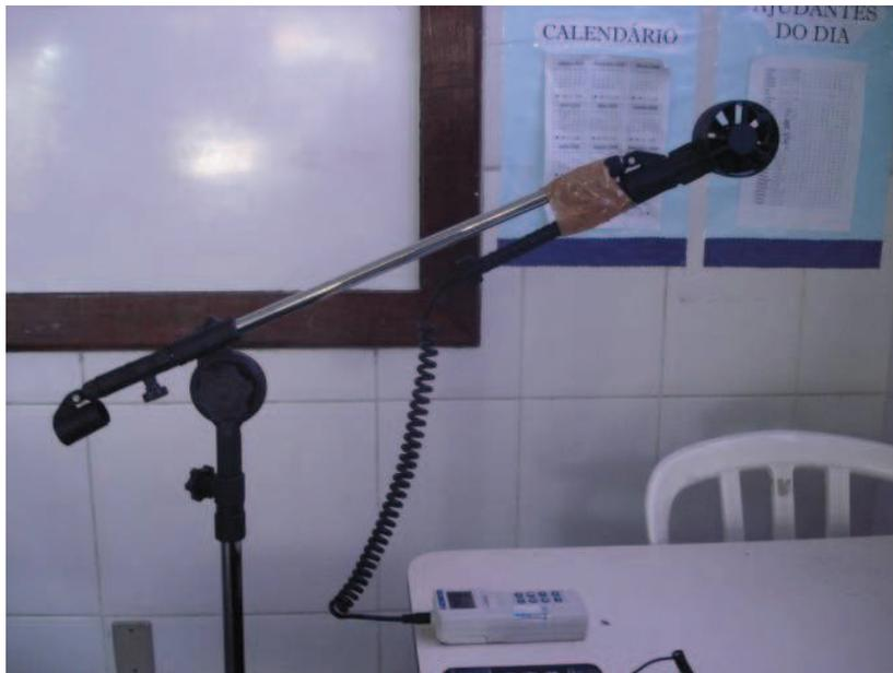
Figura 34 - Anemômetro de palhetas
