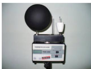
Figura 3 – Medidor das temperaturas e IBUTG
