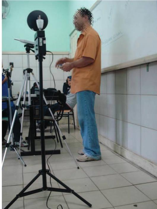
Figura 15 – Localização dos equipamentos de medição para fins de avaliação ocupacional.
