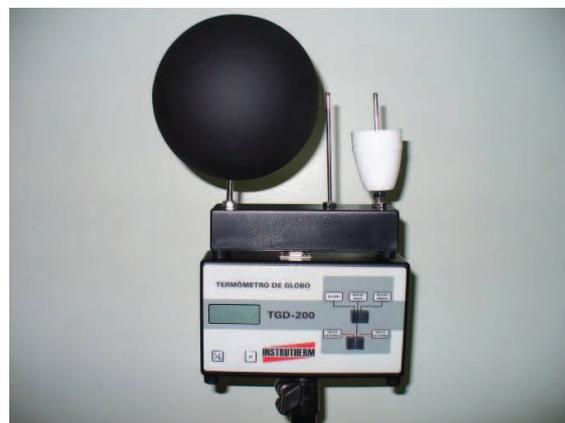
Figura 33 – Termômetro de globo (IBUTG)
