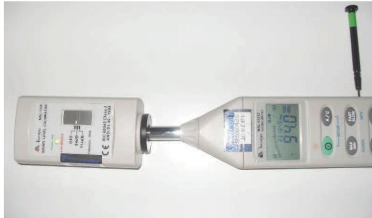
Figura 32 – Calibrador Acústico e Medidor de Nível de Pressão Sonora
