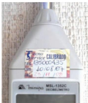
Figura 30 – Selo de calibração do equipamento com data de registro
