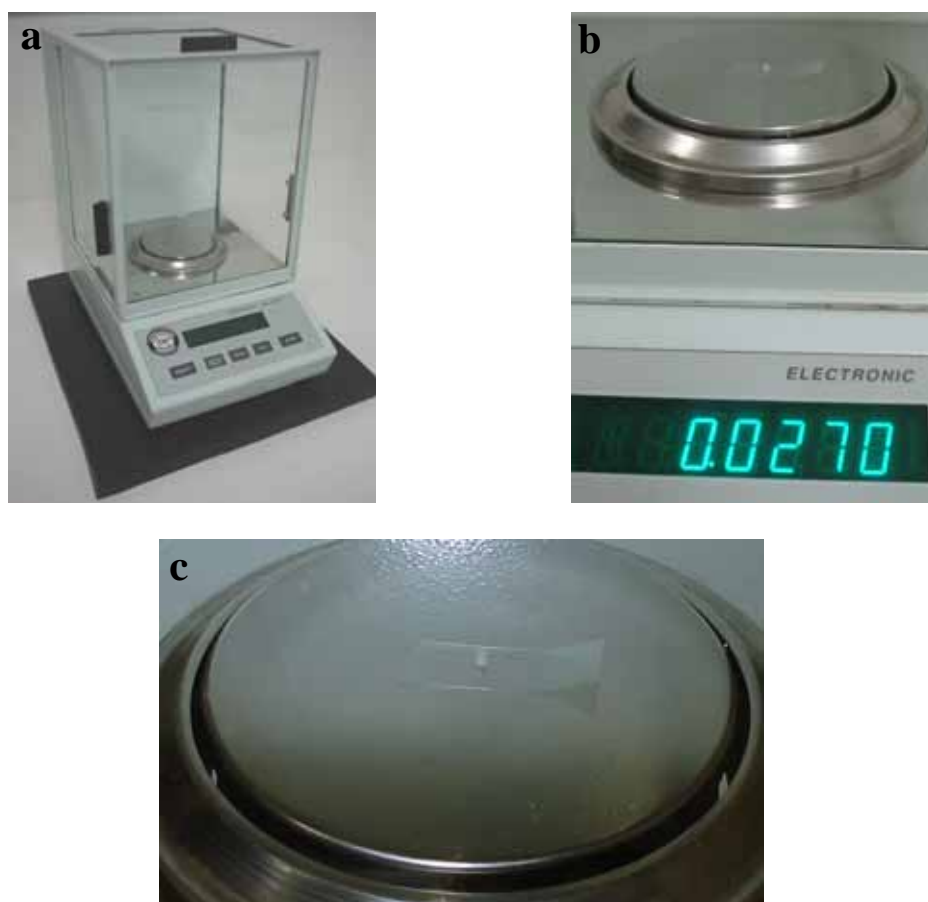
Figura 11 – Balança analítica digital (a) e verificação da massa do espécime saturado no sistema adesivo (b, c).
