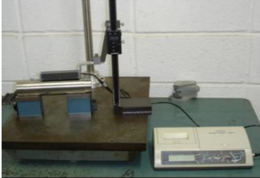
**Figura 19** - Rugosímetro portátil utilizado
