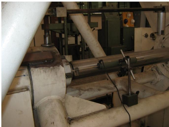
Figura 2.19 - Flexímetro “Flex 05” utilizado para medir o avanço do braço de tração.
