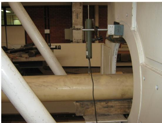
Figura 2.20 - Montagem do Flexímetro "Flex 06" utilizado para medir flecha do duto.
