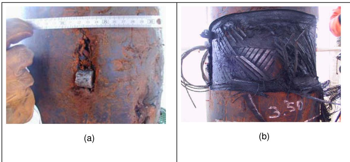
Figura 1.4 - Inspeção mostrando (a - camada plástica externa de um duto flexível de exportação de gás danificado por objetos incrustados durante a instalação; b - arames rompidos devido ao processo corrosivo em consequência indireta da ruptura da camada plástica externa do duto (ANDERSON *et al.*, 2007)).
