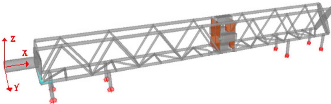
Figura 2.8 - Visualização do modelo numérico do Quadro de Teste.
