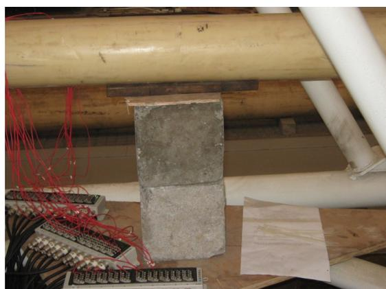
Figura 2.21 - Calço utilizado sob o duto para minimizar a flecha inicial.
