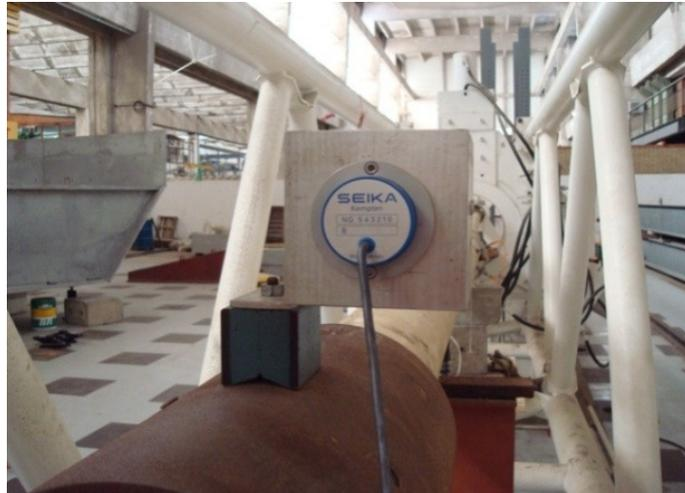
Figura 2.22 - Inclinômetro "Incl 01" utilizado para medir a rotação do duto no extremo final.
