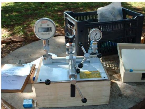
**FOTO 1.** Bomba de calibração com manômetro padrão digital.
