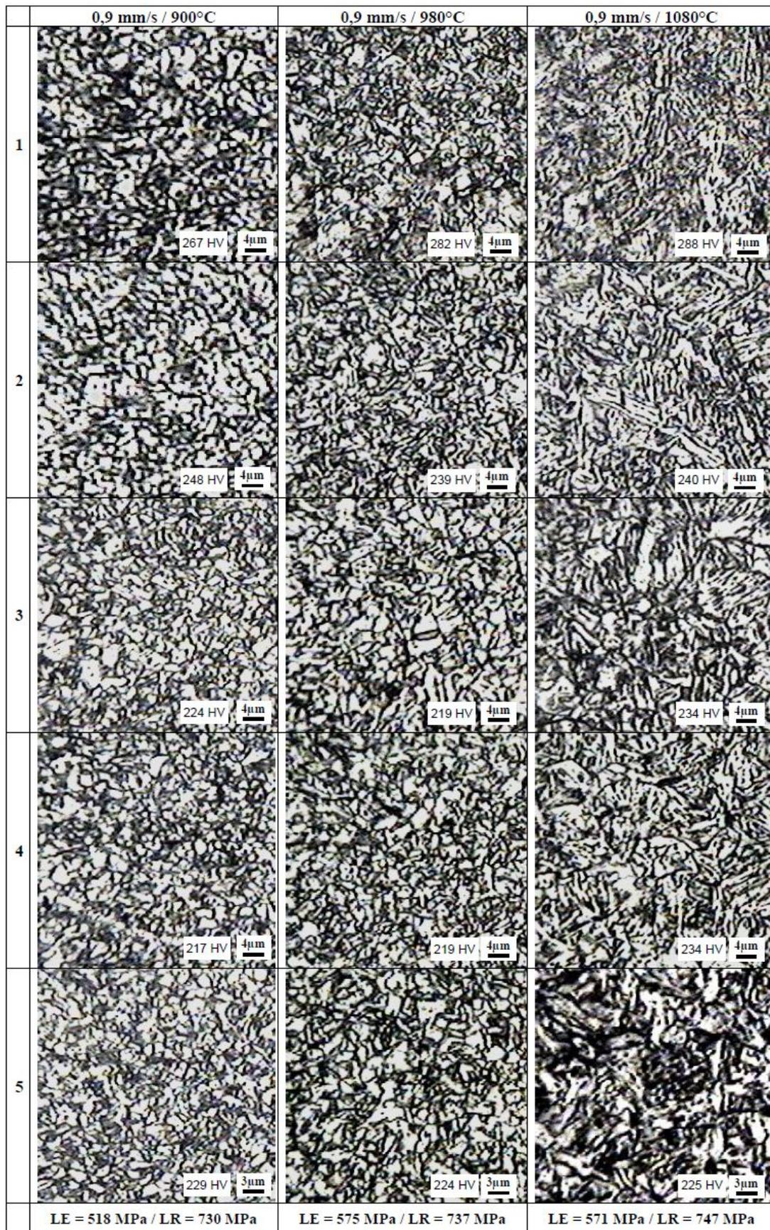
FIG. 9.4. Micrografia ótica do tubo reto tratado na velocidade de 0,9 mm/s e nas temperaturas de 900, 980 e 1080°C.
