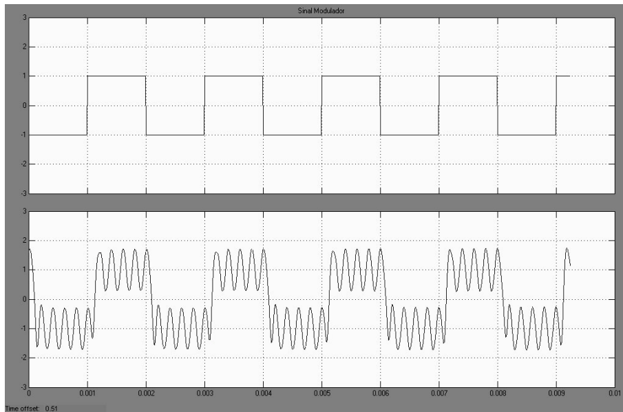
FIG. 5.3 - Sinal AM na presença do bloqueador por varredura, teste 5.
