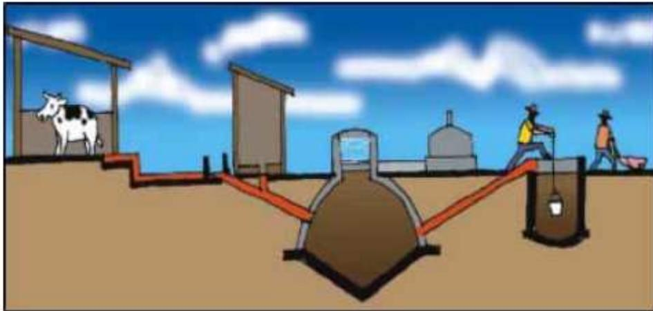
Figura 3: biodigestor de produção contínua
