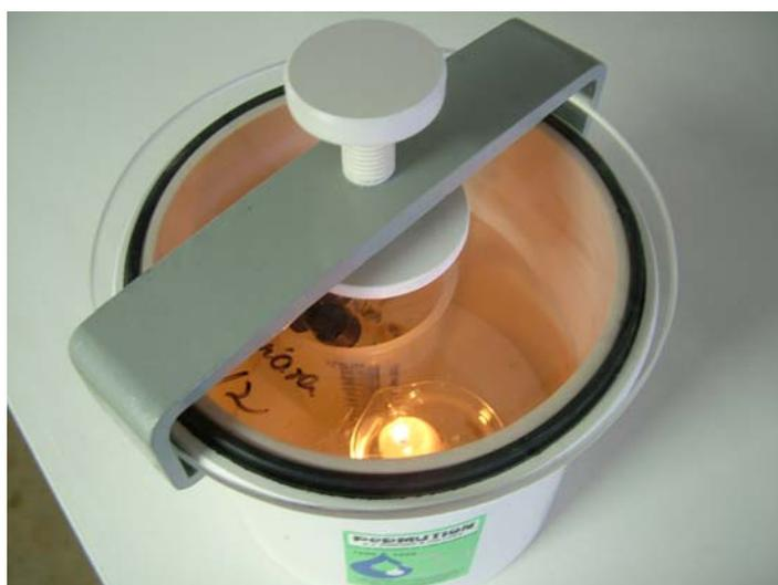
Figura 4 – Jarra de anaerobiose com vela acesa para remoção do oxigênio e liberação de CO<sub>2</sub>, necessário ao cultivo de *S. mutans* e *L. casei*.
