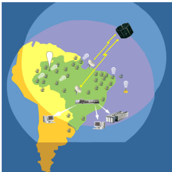
Figura 2 - Os componentes de enlace da comunicação do Sistema Brasileiro de Coleta de Dados. FONTE: http://satelite.cptec.inpe.br/PCD/sistema.jsp
