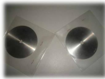
Figura 4.1.7-3 – Placas de orifício de 7,1 e 9,1mm do projeto
