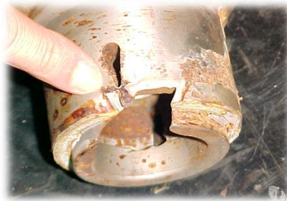
Figura 2.5.3-1 – Válvula com erosão causada por flashing
