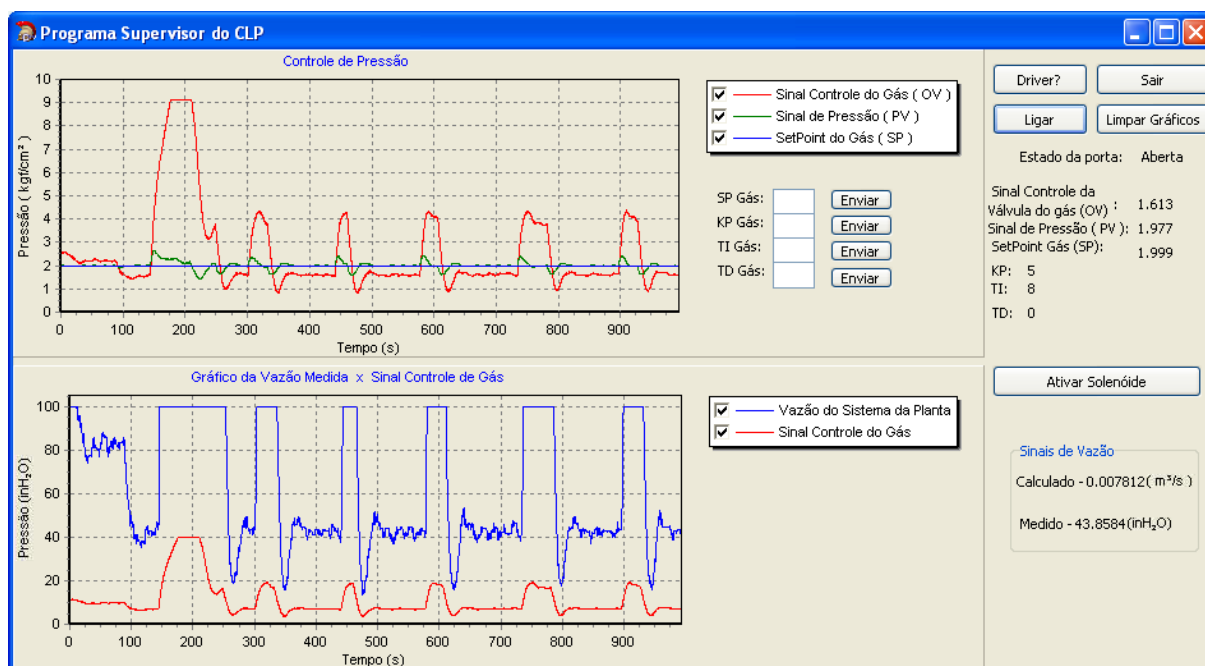
Figura 5.7-1 – Análise do sinal de controle comparado com o diferencial de pressão
