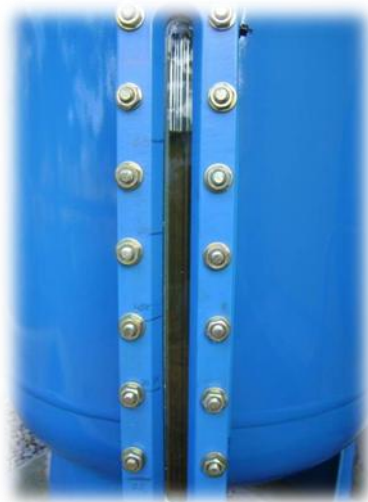
Figura 5.3-1 – Medidor visual de nível marcando as porcentagens medidas
