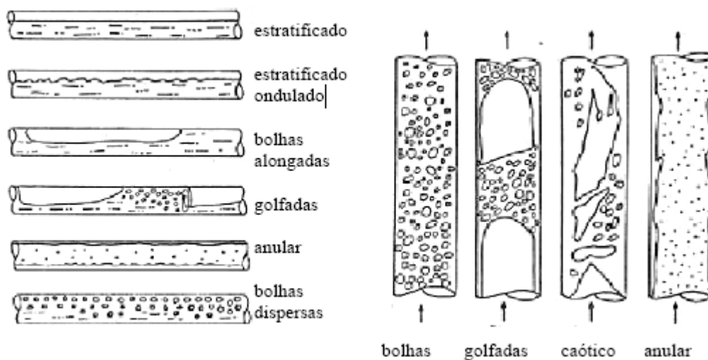
Figura 2.3.1-1 – Diagramas esquemáticos dos padrões de escoamento para os fluxos vertical e horizontal.
